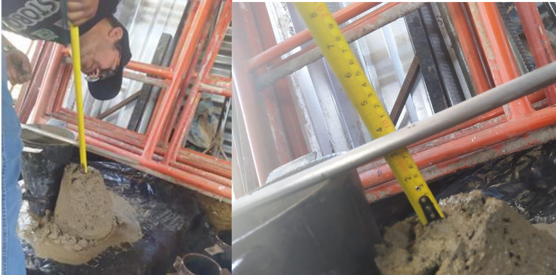
Imagen 31 Ensayo Para Determinar El Asentamiento Del Concreto NTC 396
