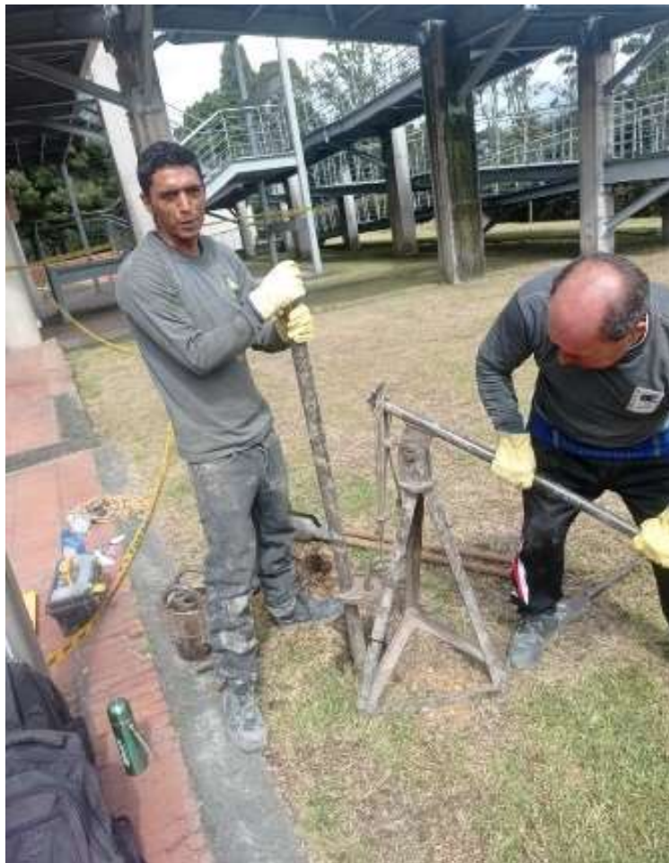
Ilustración 25. Extracción de muestras. Fuente: propia.
