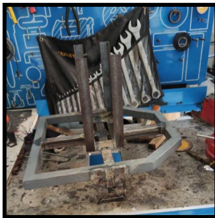
Figura 55. Construcción del chasis del robot vista lateral (autor)
