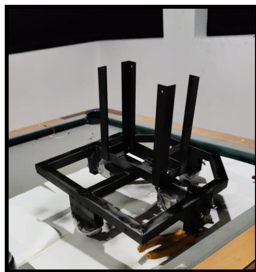
Figura 60. Etapa de pintura del chasis del robot (autor)
