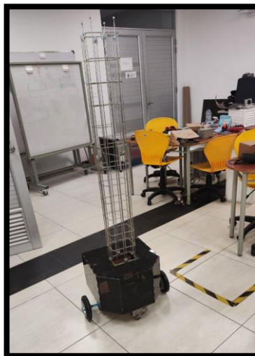
Figura 63. Ensamblaje de la carrocería con el chasis (autor)
