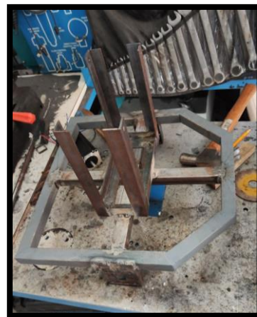
Figura 56. Construcción del chasis del robot vista superior (autor)
