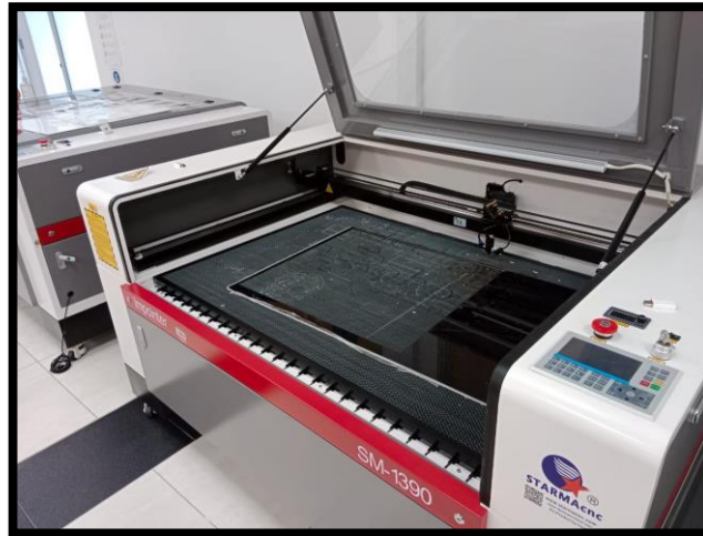
Figura 61. Corte de la carrocería en laser (autor)
