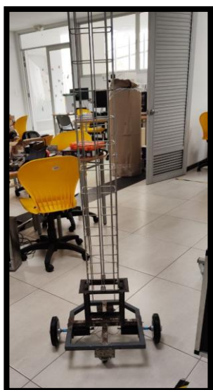
Figura 59. Montaje de motores y ruedas al chasis del robot (autor)
