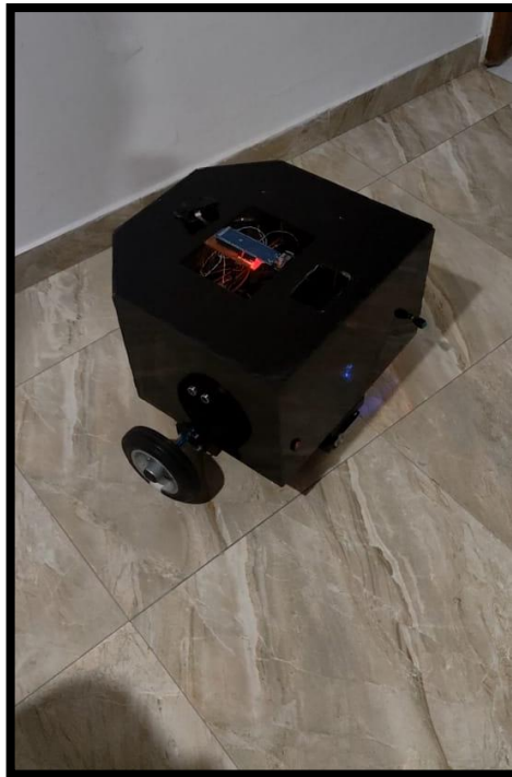
Figura 91. Robot en sus primeras pruebas a la detección de un obstáculo (la pared) (autor)
