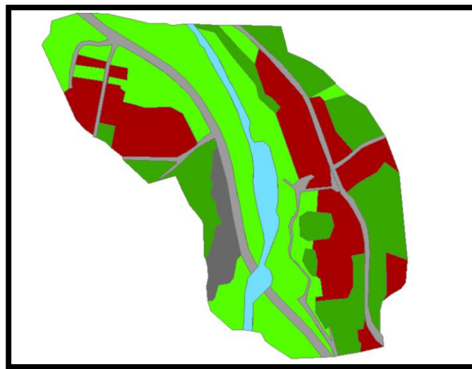
Figura 26. Clasificación del uso del suelo y asignación espacial de coeficientes de rugosidad de Manning (n) en el área de estudio. (Elaboración propia).
