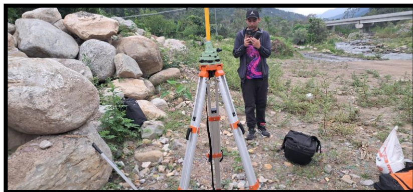
Figura 13. Apoyo técnico del ISER durante la toma de datos topográficos en campo, empleando estación GNSS para la caracterización del cauce. (Elaboración propia).
