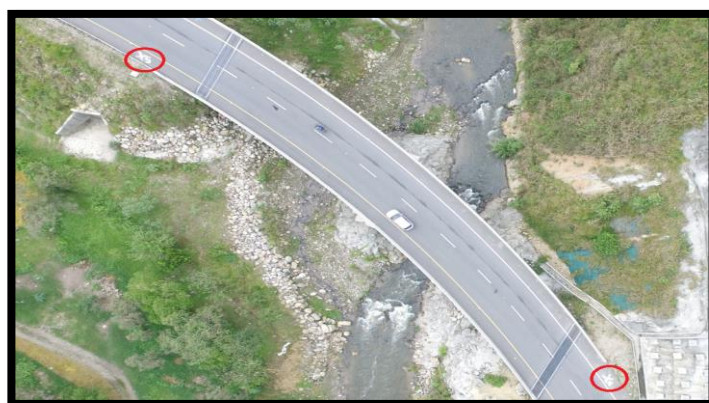
Figura 11. Puntos de control terrestre 4 y 5 ubicados sobre el eje vial que cruza el cauce del río, usados para la georreferenciación precisa del modelo. (Elaboración propia).
