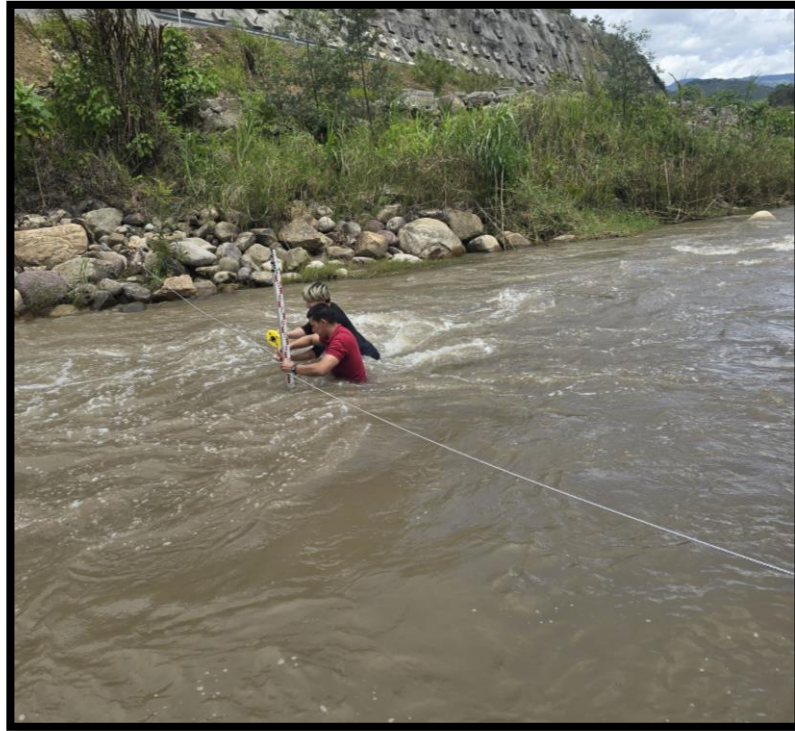
Figura 37. Realización de aforo en el río Pamplonita mediante el método de flotador, en el sector conocido como “El Diamante”. Se observa la medición de profundidades para definir la sección transversal del canal. (Elaboración propia).
