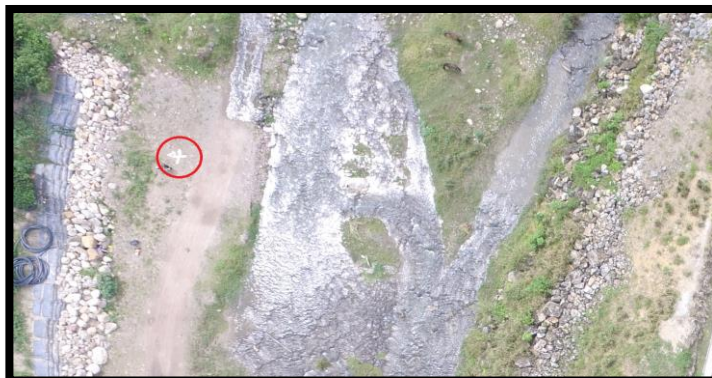
Figura 10. Ubicación y visualización aérea de un punto de control terrestre (GCP) marcado en campo con cruz blanca y centro rojo, utilizado para la georreferenciación precisa del modelo. (Elaboración propia).
