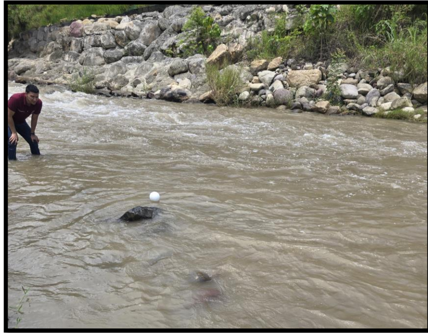
Figura 39. Observación del desplazamiento de la esfera de icopor utilizada para el aforo por flotador, con el fin de determinar el tiempo de recorrido entre las estacas de la sección medida. (Elaboración propia).
