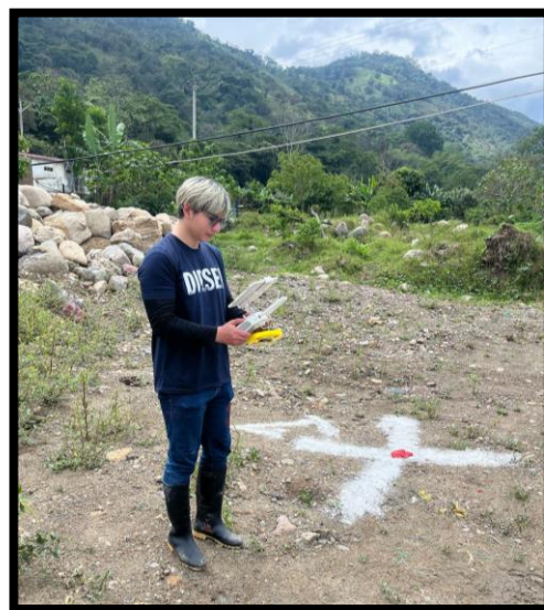
Figura 9. Registro del inicio del vuelo fotogramétrico con dron para la captura de imágenes aéreas del cauce y su entorno. (Elaboración propia).
