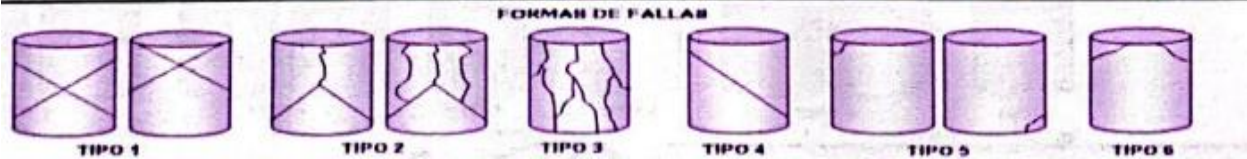
Ilustraciones 48. Formas de fallas de cilindros. Invias E-410-13
