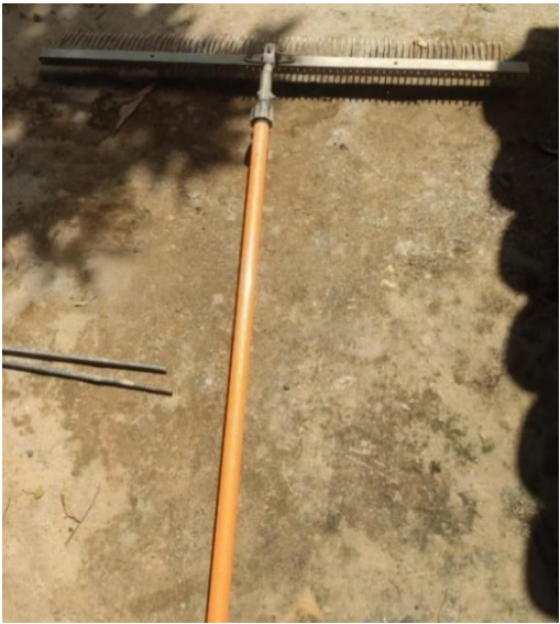
Ilustración 13. Flotadora de concreto. fuente propia
