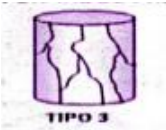
Ilustraciones 50. Falla tipo 3. INVIAS E-410
