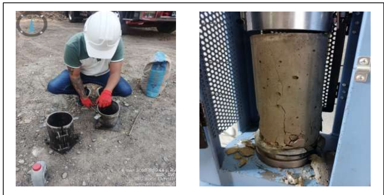
Figura 137. Ensayo de resistencia en campo.
