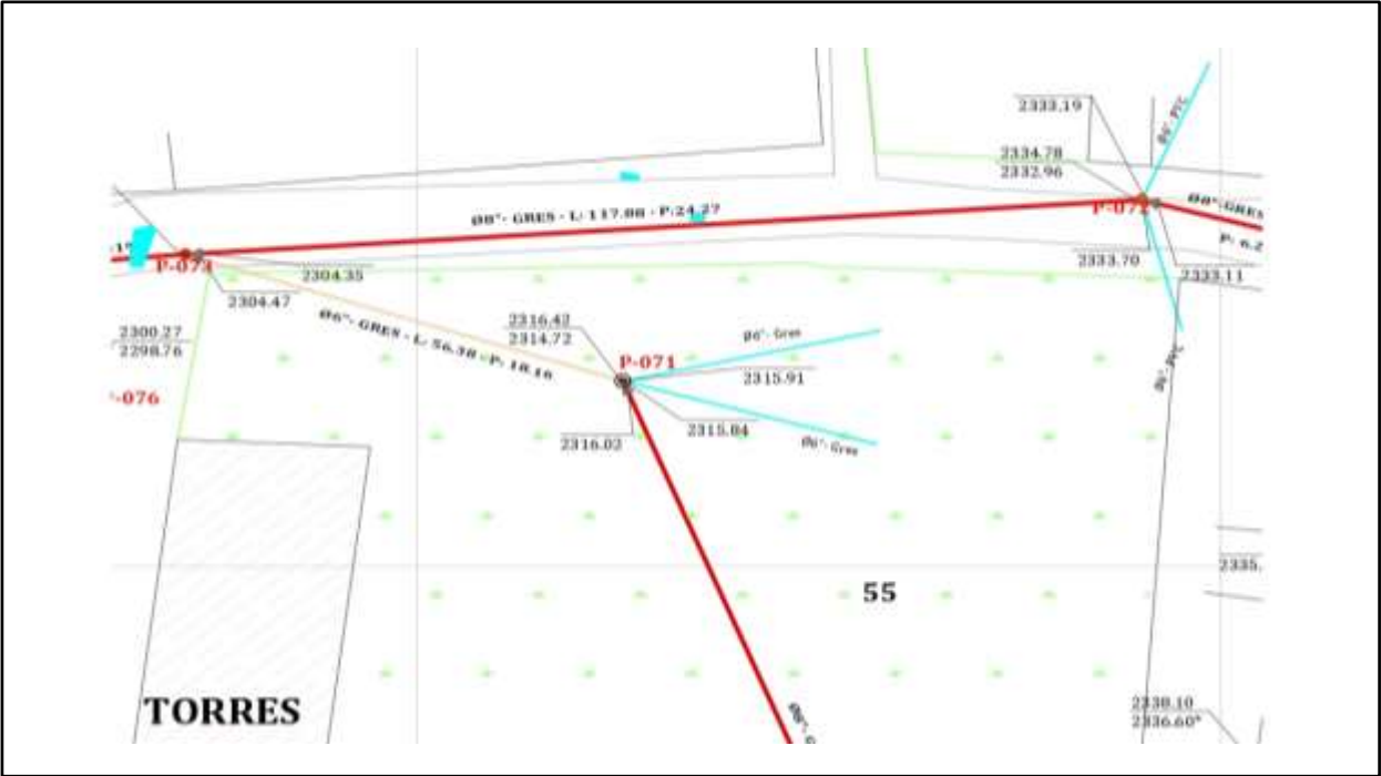
Figura 99. Tramo de alcantarillado Calle 3 entre Cra. 8 y 9.
