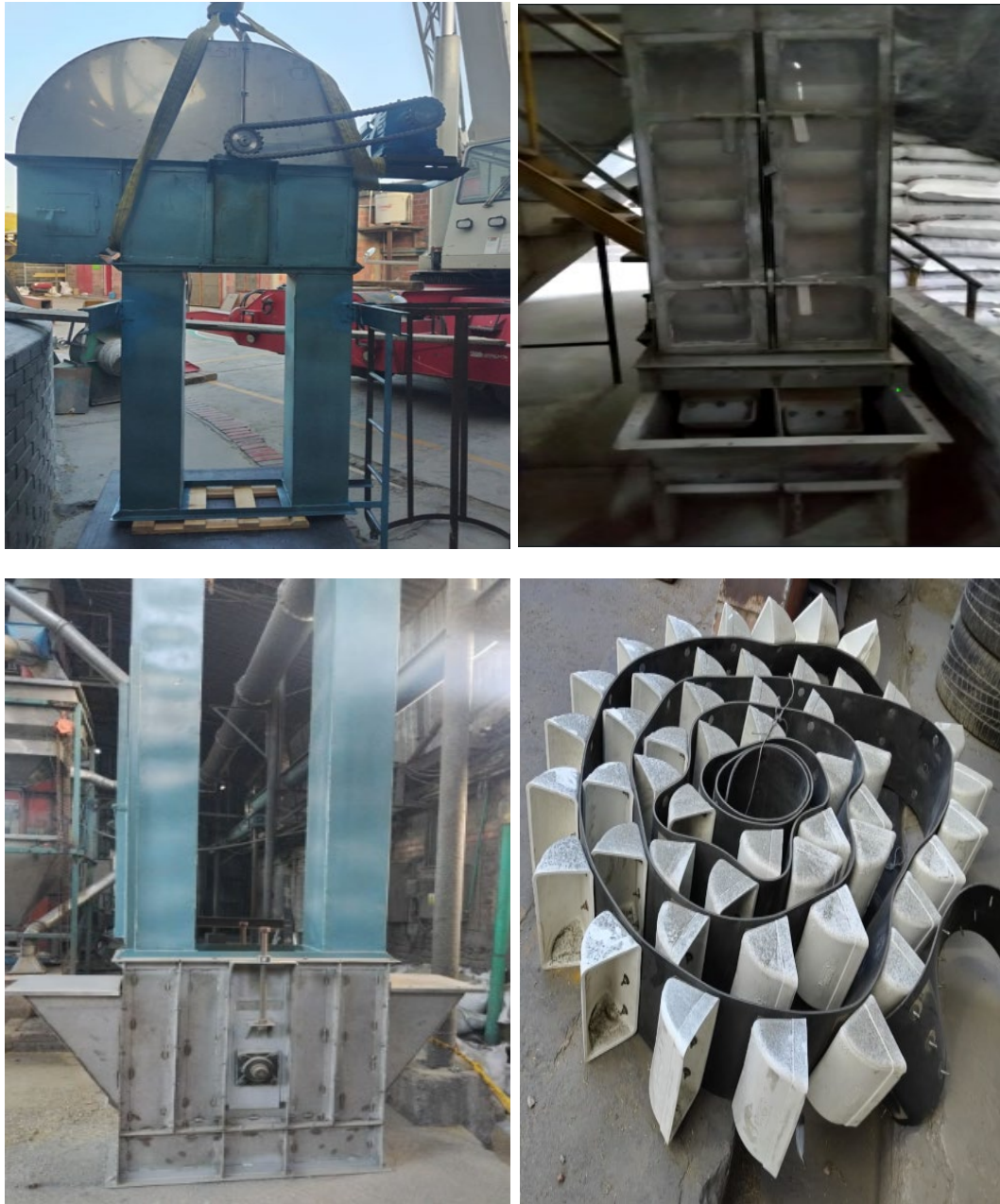
Ilustración 12: Partes del elevador de cangilones
