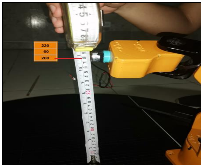
Figura 189. Validación de la Trayectoria Continua (manipulador real en y)
