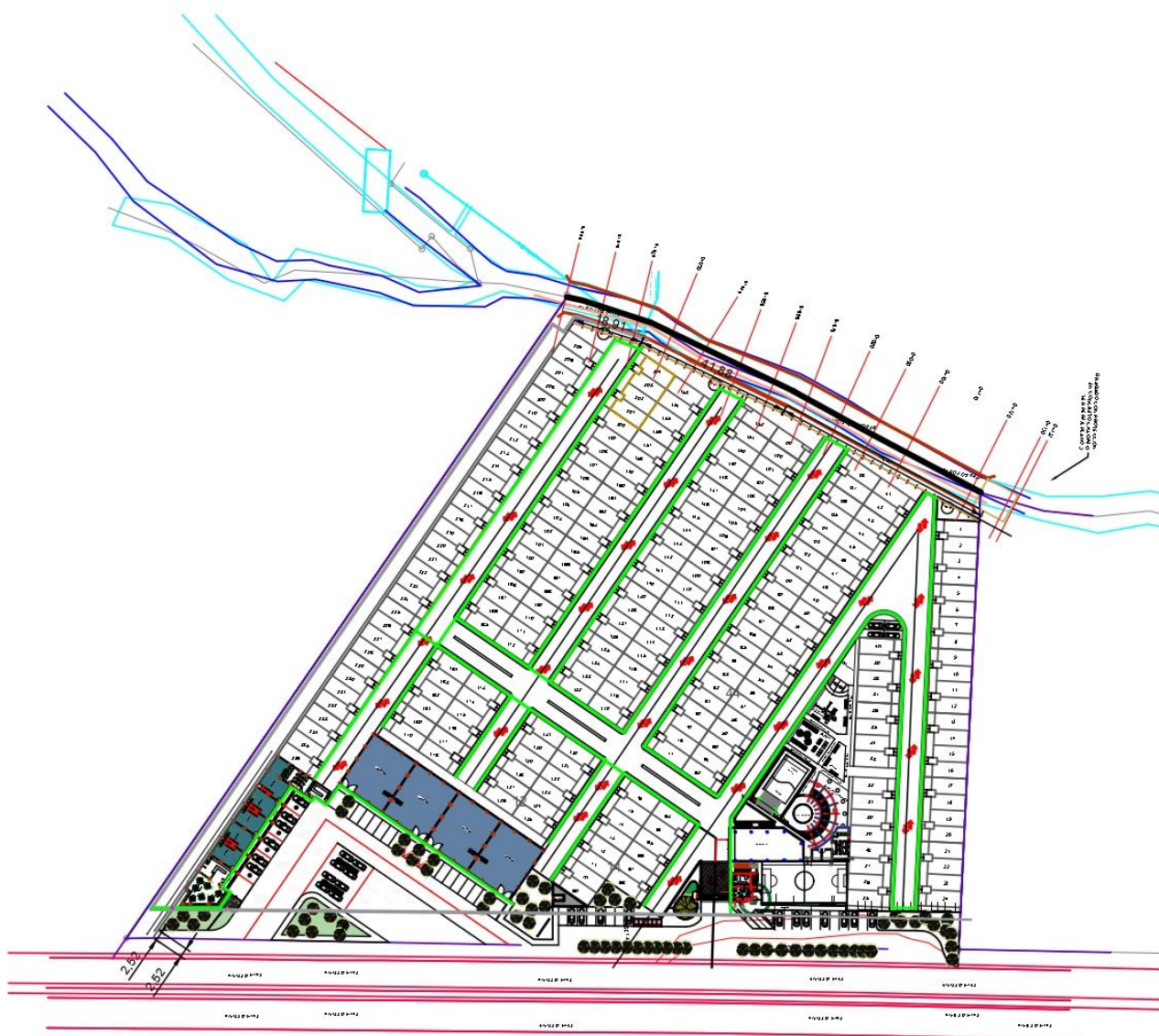
Ilustración 9. Plano del trazado para el anillado interno y Troncal 110mm, Proyecto Sanara House
