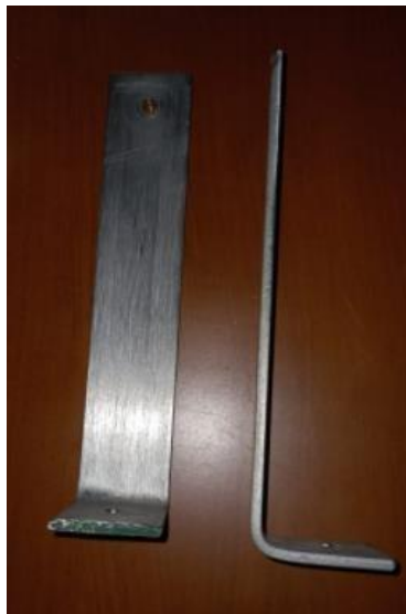
Figura 54 L para soporte del carril. Autoría propia
