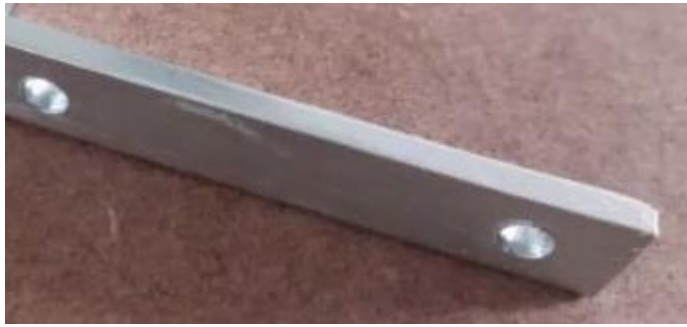
Figura 66 Lamina para rigidez del riel. Autoría propia
