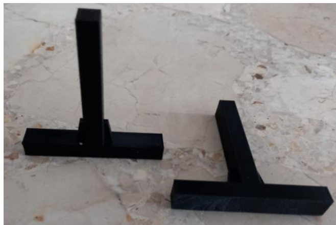
Figura 75 Piezas soporte actuador. Autoría propia
