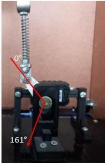
Figura 423 Posición angular de la manivela. Autoría propia
