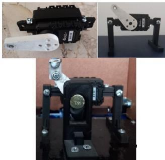
Figura 81 Ensamble de actuador y potenciómetro. Autoría propia
