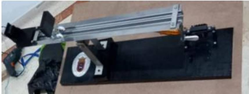
Figura 82 ball and beam. Autoría propia
