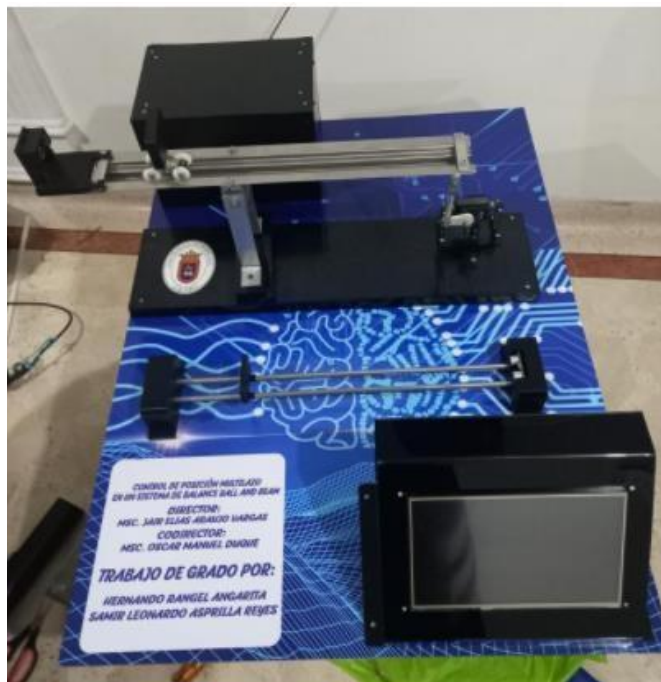
Figura 92 Montaje de los componentes físicos sin la parte eléctrica. Autoría propia
