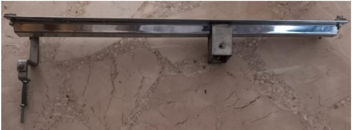
Figura 74 Ensamble de las piezas de transmisión de movimiento, el perfil y la pieza de unión de las L. Autoría propia
