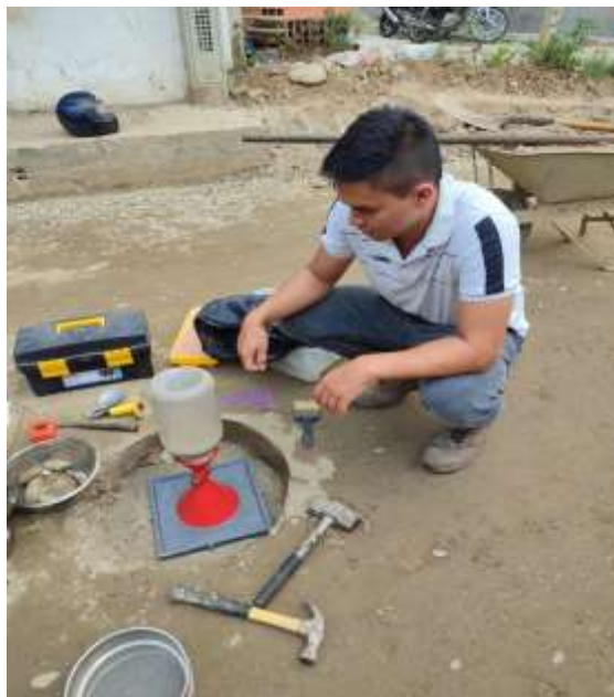
Ilustración 62. Ensayo de densidad de cono y arena en la base granular.
