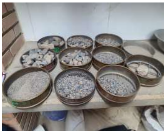
Ilustración 75. Imagen de laboratorio, resultado del tamizaje de la sub base granular de la calle 35 entre avenidas 7 y 10 del barrio la sabana.
