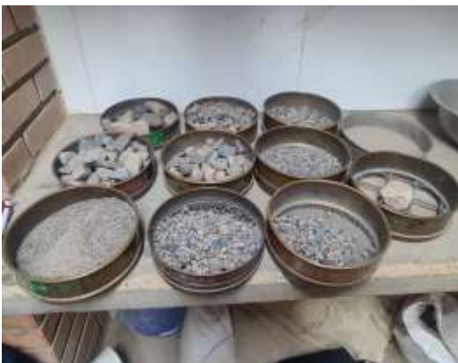
Ilustración 11. Imagen de laboratorio, resultado del tamizaje de la sub base granular de la calle 35 entre avenidas 7 y 10 del barrio la sabana.
