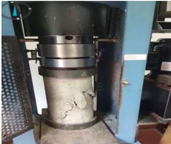
Ilustración 69. Imagen de laboratorio, cilindro de concreto ensayado.
