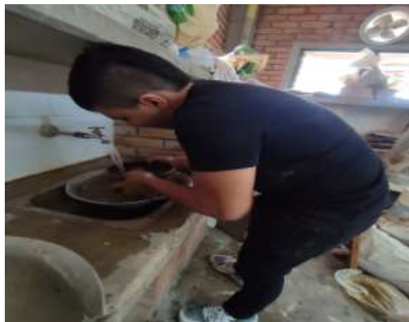
Ilustración 72. Imagen de laboratorio, lavado del material sobre el tamiz n°200 de la sub base granular de la calle 35 entre avenidas 7 y 10 del barrio la sabana.
