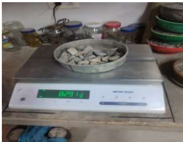
Ilustración 10. Imagen de laboratorio, tamizaje de la sub base granular de la calle 35 entre avenidas 7 y 10 del barrio la sabana.
