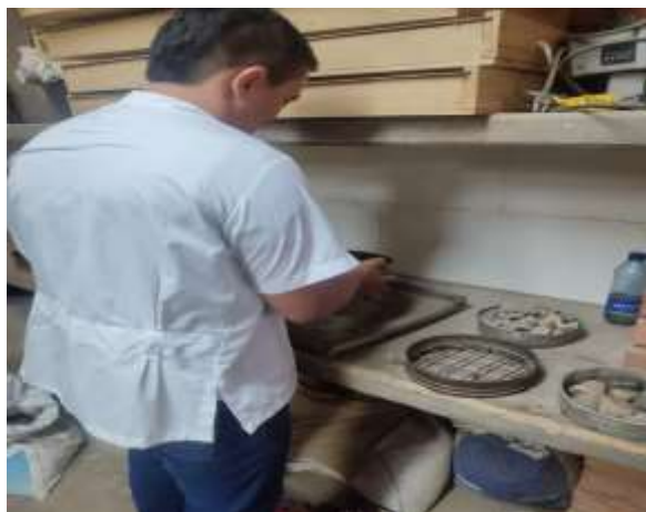
Ilustración 9. Imagen de laboratorio, tamizaje de la sub base granular de la calle 35 entre avenidas 7 y 10 del barrio la sabana.
