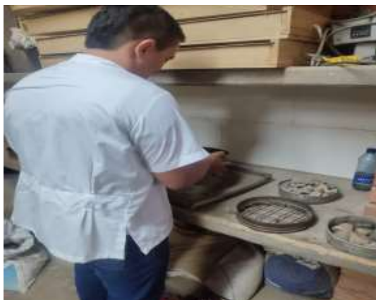
Ilustración 73. Imagen de laboratorio, tamizaje de la sub base granular de la calle 35 entre avenidas 7 y 10 del barrio la sabana.
