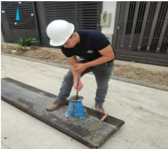
Ilustración 63. Imagen de campo, compactación con 25 golpes de la varilla.
