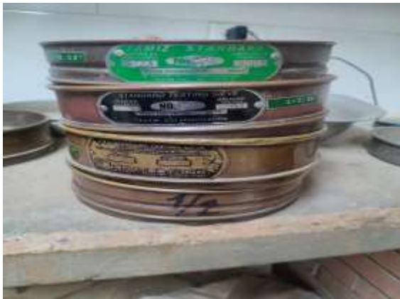
Ilustración 76. Imagen de laboratorio, tamices para en ensayo de la sub base granular de la calle 35 entre avenidas 7 y 10 del barrio la sabana.
