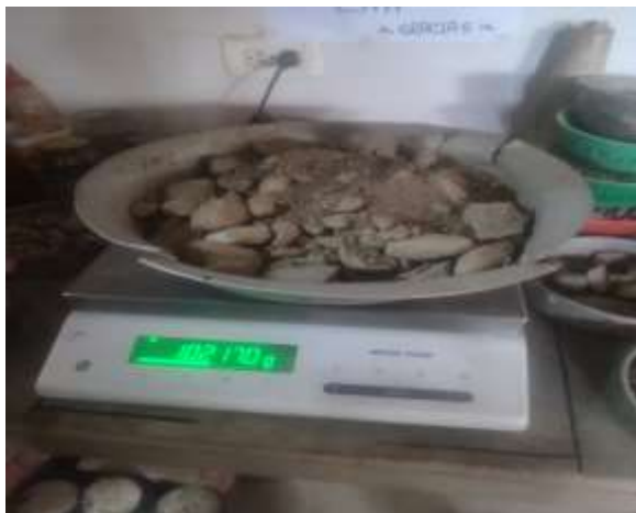
Ilustración 71. Imagen de laboratorio, peso de la muestra inicial secada al sol de la sub base granular de la calle 35 entre avenidas 7 y 10 del barrio la sabana.
