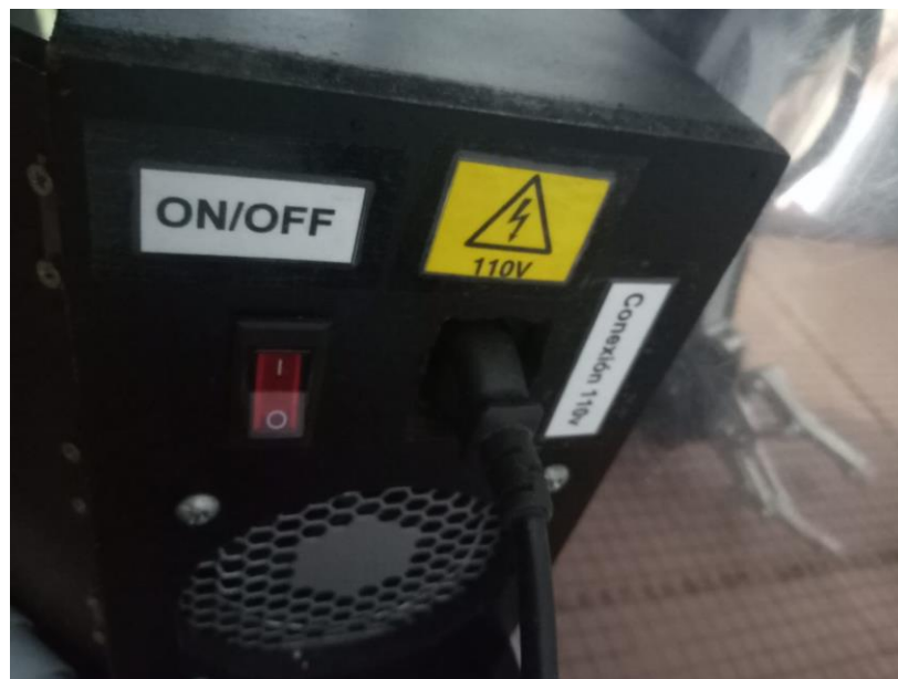
Ilustración 6.12: Interruptor de alimentación general del sistema. Fuente: Autor.
