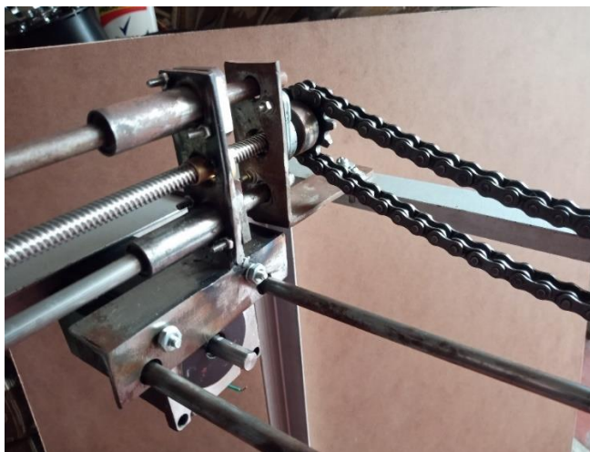
Ilustración 6.5: Imagen del sistema de ejes y guías de las articulaciones 1 y 2. Fuente. Autor.
