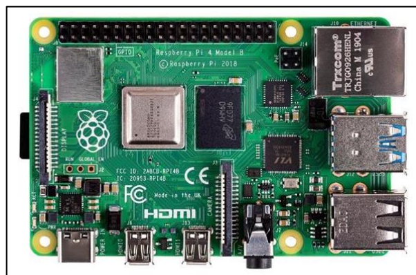
Ilustración 4.7: Tarjeta de desarrollo Raspberry pi 4 modelo b. Fuente: Raspberry
