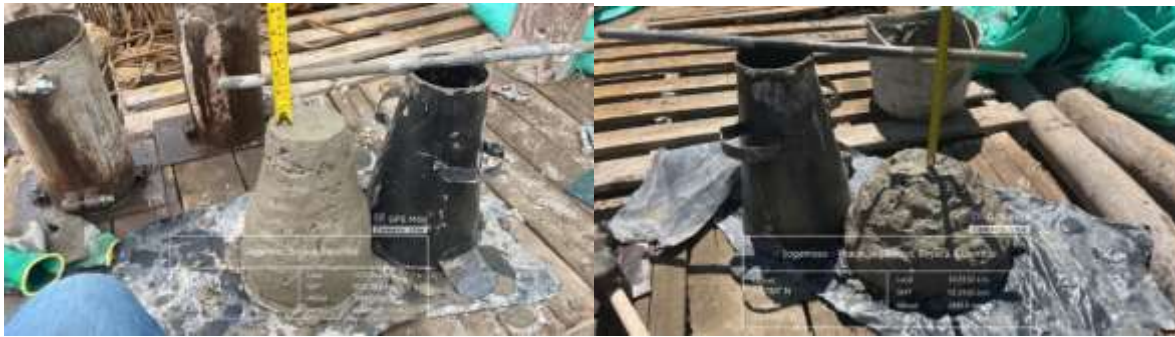
Ilustración 29. Comparativo de asentamiento de mezcla de concreto
