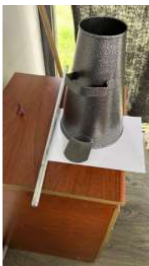
Ilustración 27. Cono de Abrams utilizado en obra.
