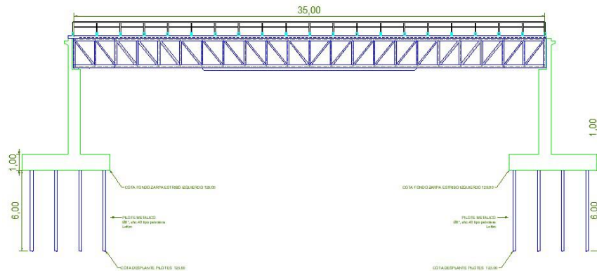
Perfil del puente, alternativa de solución No. 1
