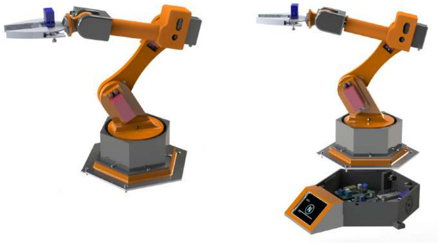
Figura 4.11: CAD de vista explosionada entre los gdl y base de electrónica. Fuente: Elaboración propia
