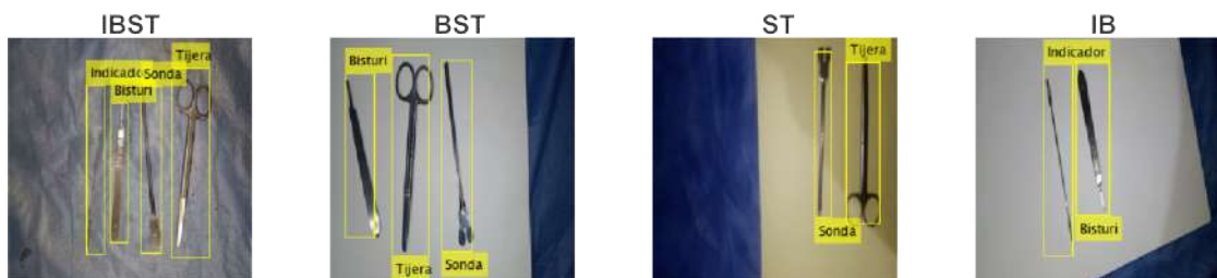
Figura 6.27: Funcionamiento de detector YOLO V3 enfocando más de un objeto en una imagen. Fuente: Elaboración propia
