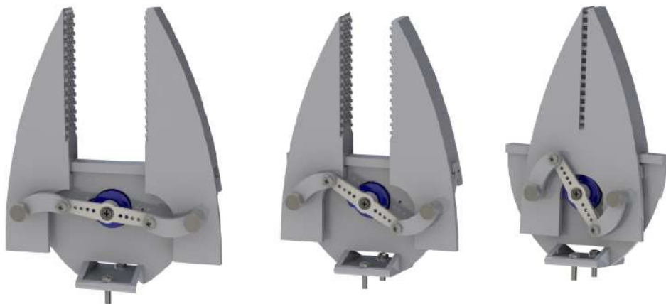
Figura 4.7: Funcionamiento del efector final mecánico Fuente: Elaboración propia
