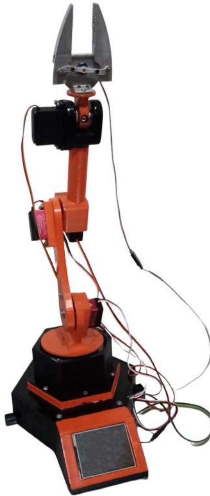
Figura 5.5: Robot antropomórfico completamente ensamblado. Fuente: Elaboración propia
