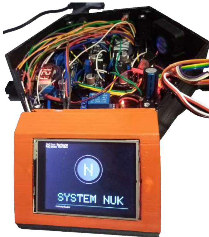
Figura 5.3: Ensamble físico y validación del funcionamiento de la base del robot en una vista frontal. Fuente: Elaboración propia
