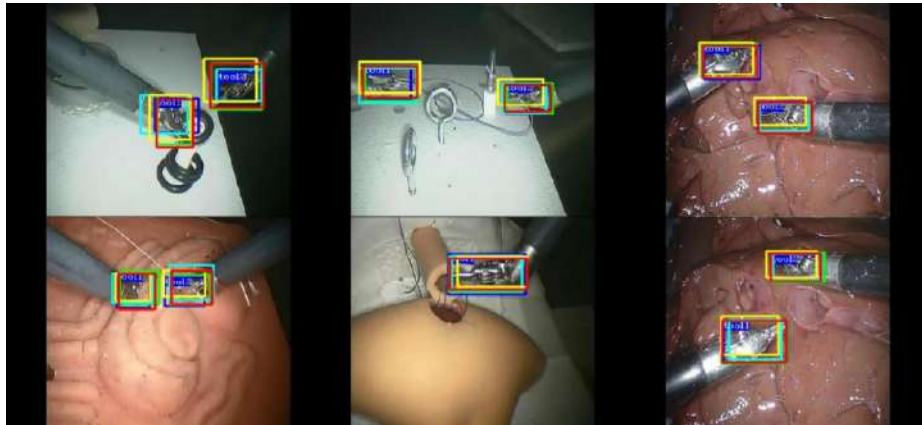
Figura 1.13: Seguimiento de herramientas quirúrgicas implementando CNN en cascada. Fuente: [16]
