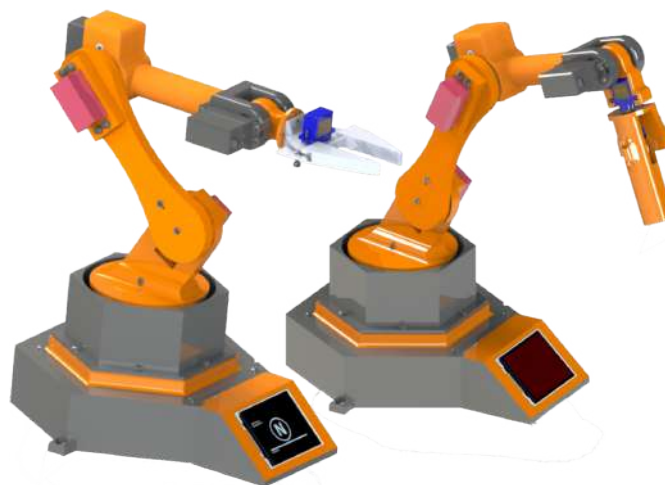
Figura 4.12: CAD de prototipo robótico para la asistencia en instrumentación quirúrgica. Fuente: Elaboración propia
