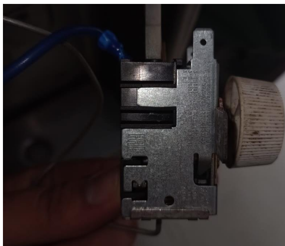
Ilustración 14. Componente en fallo, termostato Danfoss.
