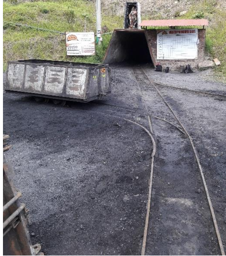
Figura 9. Carrilera y vagoneta de transporte de carbón
