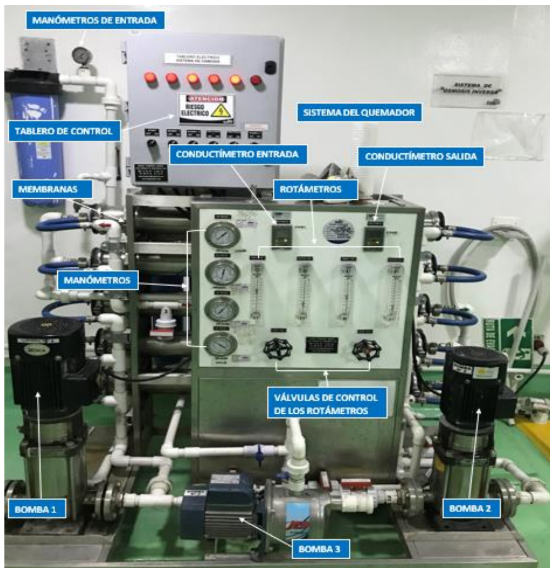
Figura 38. Esquema de planta de ósmosis inversa en cuarto de agua
