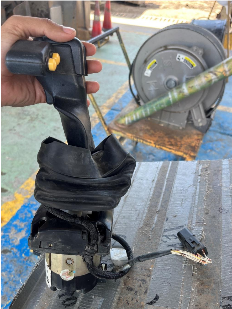
Anexo 9. Joystick desinstalado
