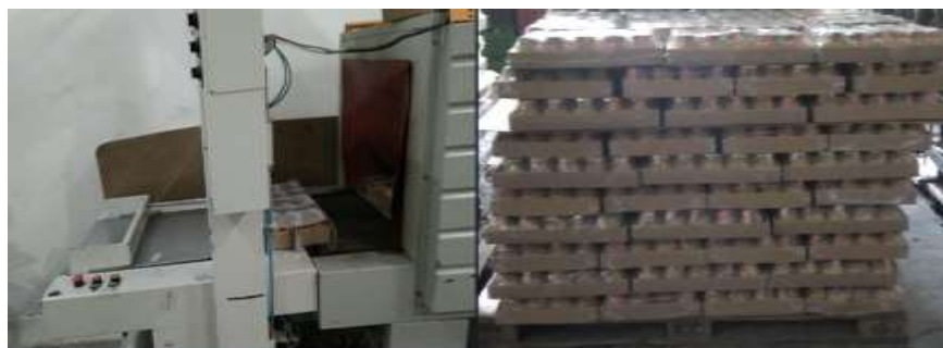
Figura 15: Enfardadora y Estiba de Producto Terminado C.O.C.
