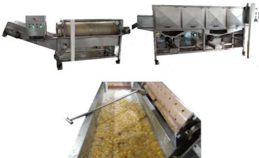
Figura 5: Sección de Lavado y Neutralización C.O.C.
