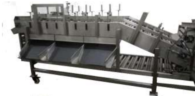
Figura 18: Segunda Sección Banda: Sistema de selección por tamaños
