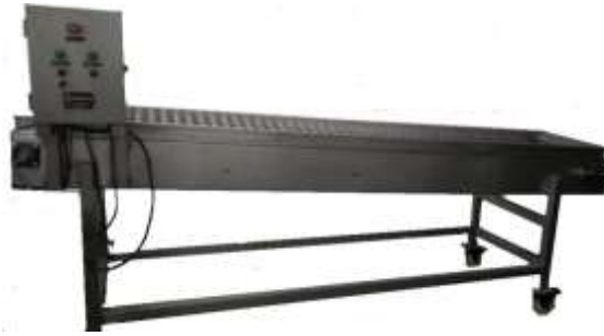
Figura 17: Primera Sección Banda: Sistema de dispersión de producto
