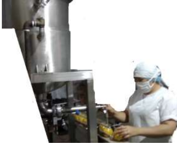
Figura 8: Marmitas Dosificadoras de Almíbar C.O.C.
