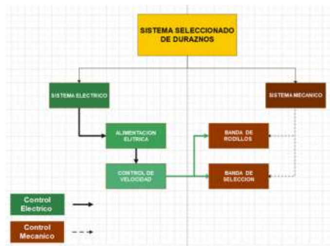
Figura 16: Diagrama Básico Seleccionadora de Duraznos
