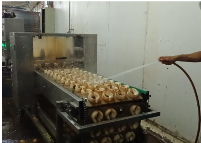
Figura 6-56. Limpieza de cadena y portadurazno
