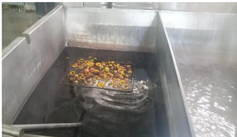
Figura 5-4. Tanque de pelado químico
