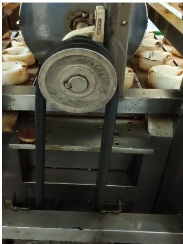
Figura 6-59. Inspección de correas de cortadora
