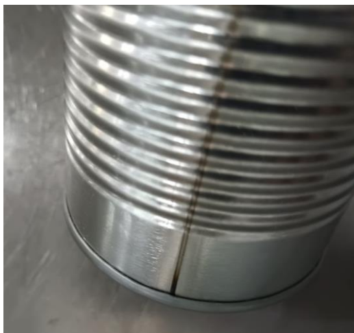
Figura 6-45. Inspección visual del buen sellado
