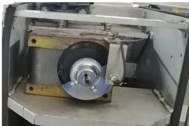
Figura 6-14. Detección de metal por el sensor PR12 – 4DN
