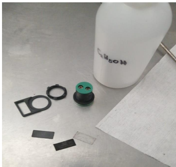
Figura 6-39. Limpieza de componentes del tablero de control
