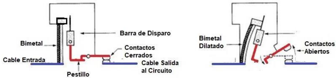
Figura 85. Protección térmica del magnetotérmico. [36]
