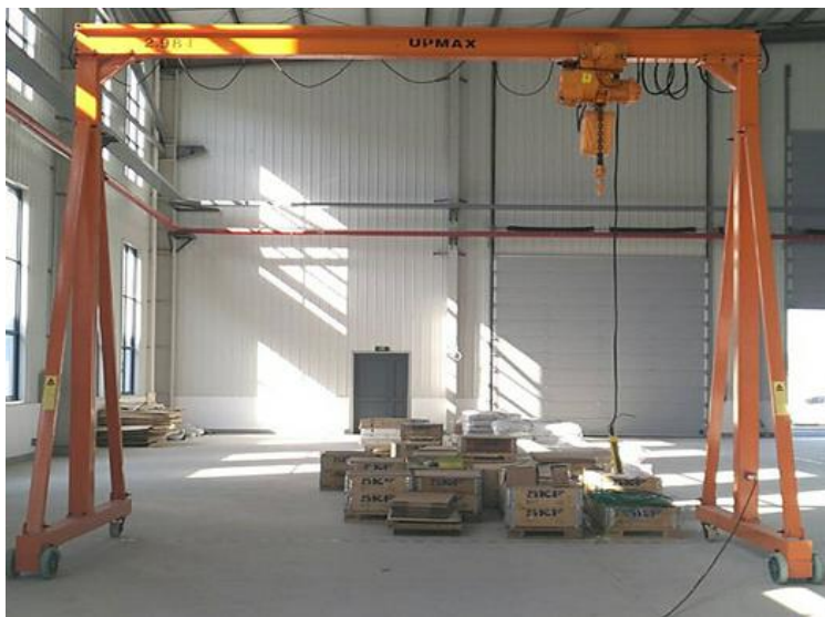
Figura 8. Puente grúa pórtico. [13]
