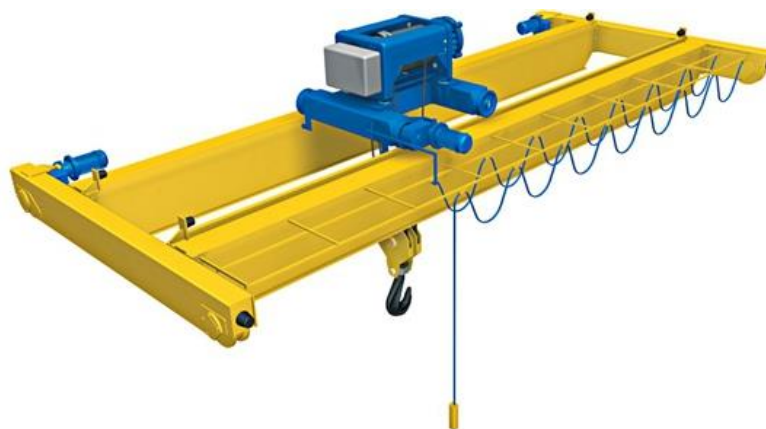
Figura 7. Puente grúa birriel. [12]
