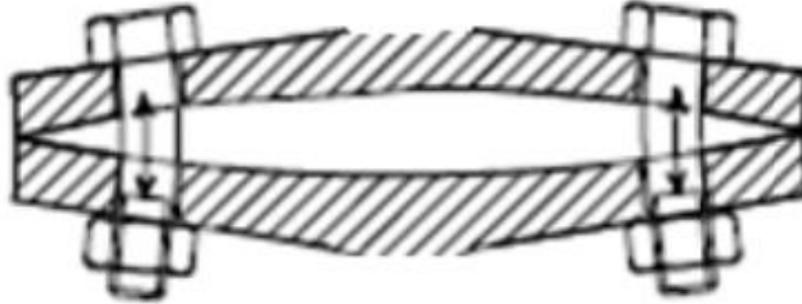
Figura 52. Esfuerzo a tensión en pernos más lejanos. [31]
