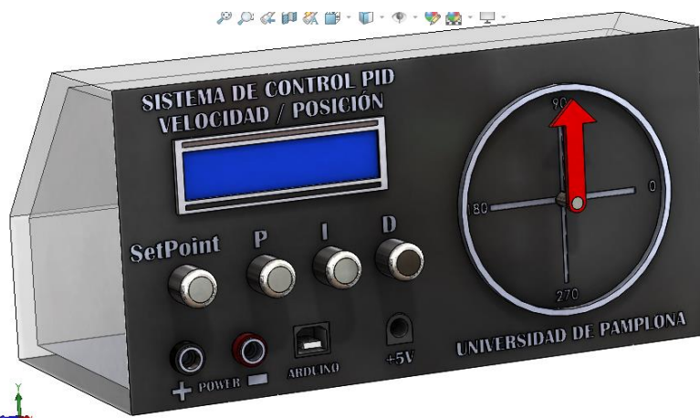
Ilustración 37 Diseño del concepto del controlador didáctico digital. Fuente elaboración propia.
