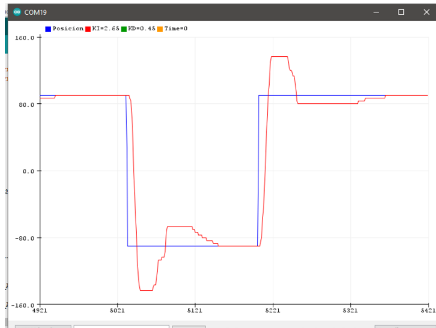
Ilustración 35 Respuesta a cambio de la constante de K_p . Fuente elaboración propia.
