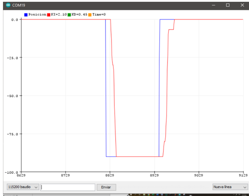
Ilustración 34 Respuesta a diferentes cambios de posición Fuente elaboración propia.
