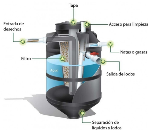
Figura 2-1: Ejemplo de Biodigestores.(aguamarket, 2017)
