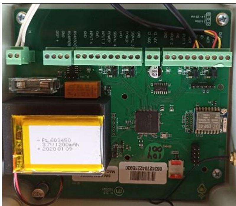
Ilustración 13. Tarjeta de control del equipo de monitoreo dataligth
