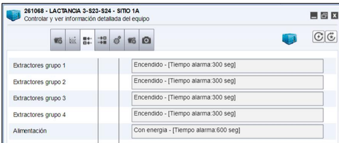
Ilustración 43. Ajuste de parametrización en los extractores
