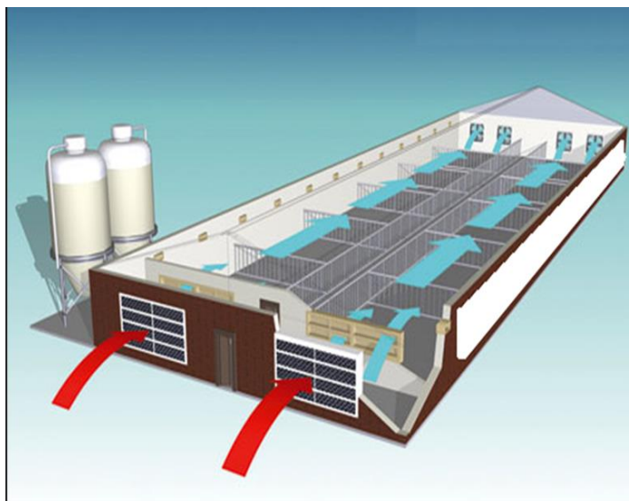
Ilustración 8. Flujo de aire a través de galpón climatizado
