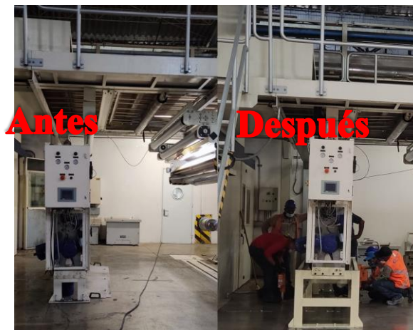
Figura 42. Comparativa de soporte antiguo vs actual. Fuente: Autor.
