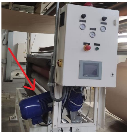
Figura 64. Motor trifásico acoplado a rodillo aplicador. Fuente: Autor.
