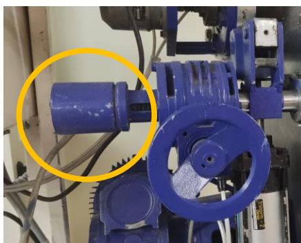
Figura 66. Encoder acoplado a rodillo de prensa. Fuente: Autor.
