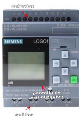
Figura 14 . Estructura física de un plc siemens categoría logo. Ajustado por: Autor.
