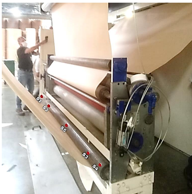
Figura 70. Representación gráfica de instalación de sensores laser para lectura de papel. Fuente: Autor.
