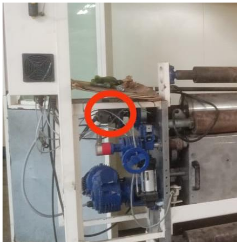
Figura 65. Tacogenerador acoplado a rodillo superior. Fuente: Autor.
