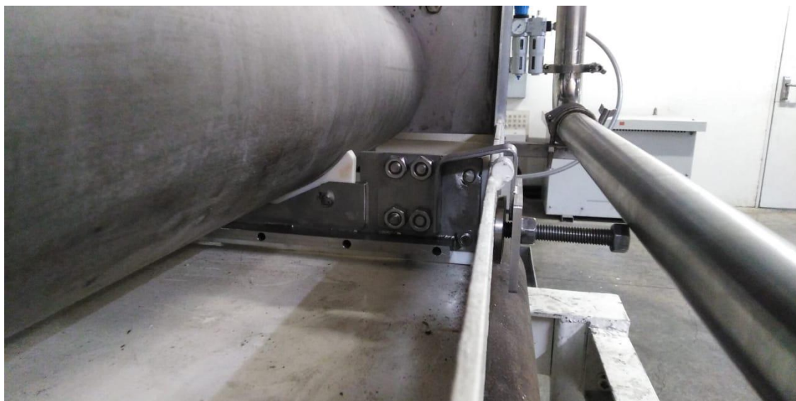
Figura 61. Instalación de limitadores de adhesivo. Fuente: Autor.
