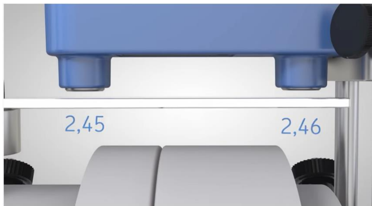
Figura 80. Medidas registradas por los sensores de proximidad.
