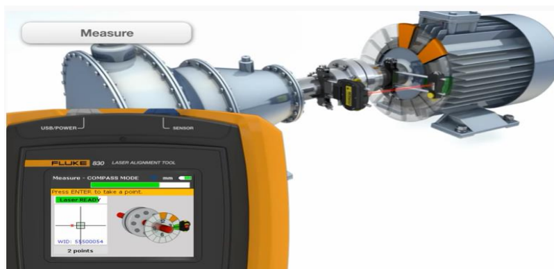
Figura 84. Toma de medidas con alineador Fluke 830.
