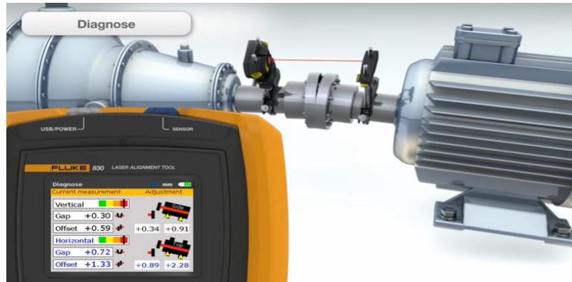
Figura 85. Datos indicados por alineador Fluke 830 para realizar movimientos de la máquina.
