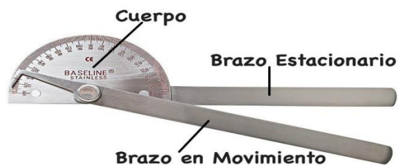
Figura 21 Partes del goniómetro.
