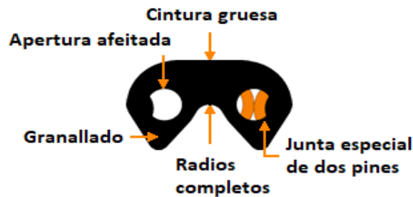
Figura 64. Eslabón de cadena SC.
