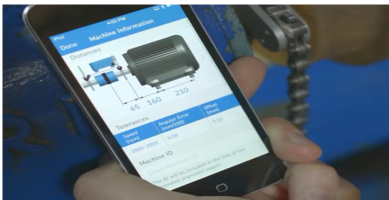
Figura 78. Información del sistema para alineación con SKF TKSA 11.
