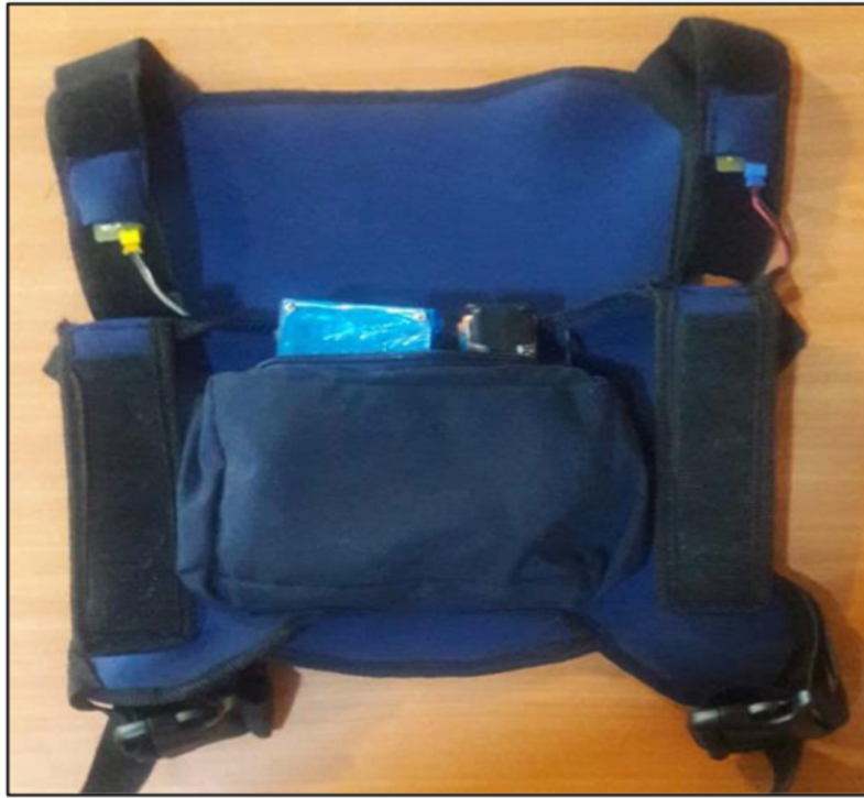
Figura 24: Montaje de elementos electrónicos en el chaleco Fuente: [17]
