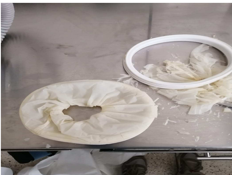
Fig. 97. Deterioro de los tapones debido a los cambios de temperatura.
