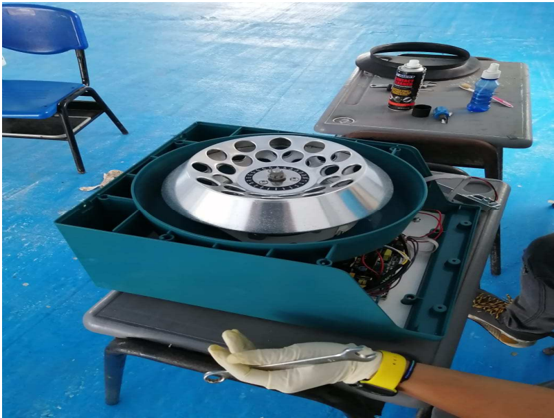
Fig. 45. Rotor del equipo limpio y desinfectado.
