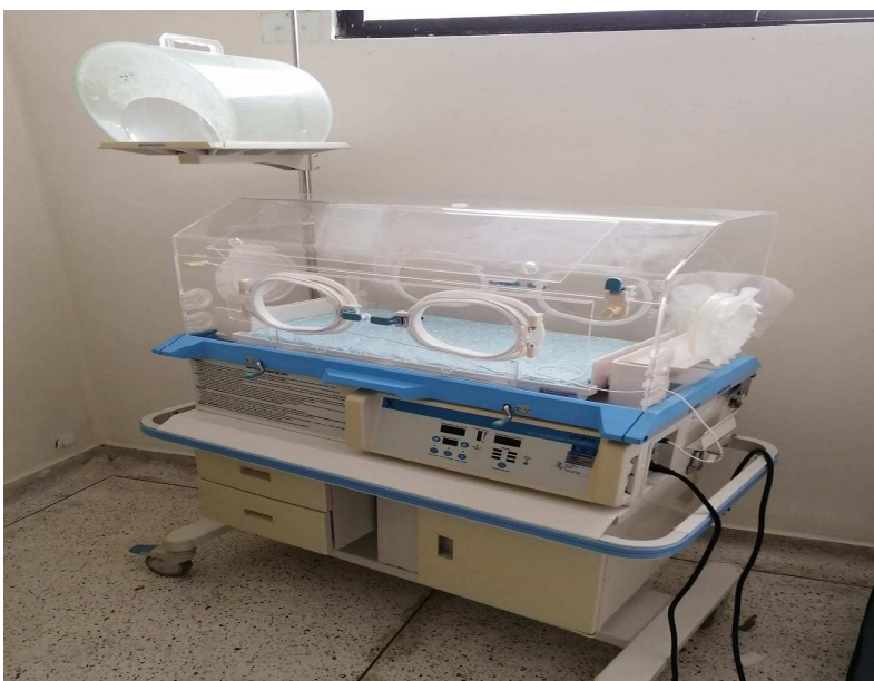
Fig. 93. Equipo incubadora pediátrica perteneciente al servicio de hospitalización de la ESE Hospital Alcides Jiménez, que requería mantenimiento preventivo como limpieza y desinfección de bandeja con agua destilada para que el equipo mantenga la humedad requerida, limpieza y desinfección de los empaques de los tapones, cambio de tela de los tapones debido a desgaste por cambio de temperaturas.
