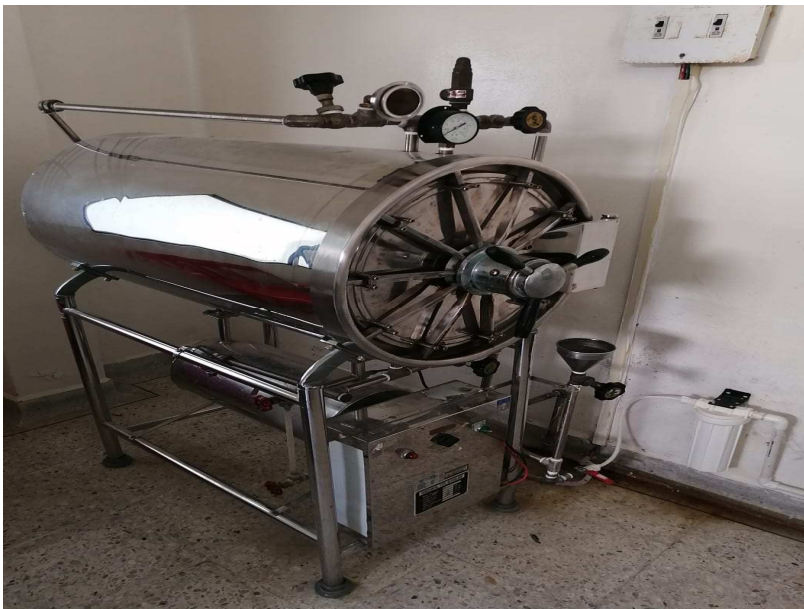
Fig. 35. Equipo autoclave manual al que se le realizo el mantenimiento correctivo.
