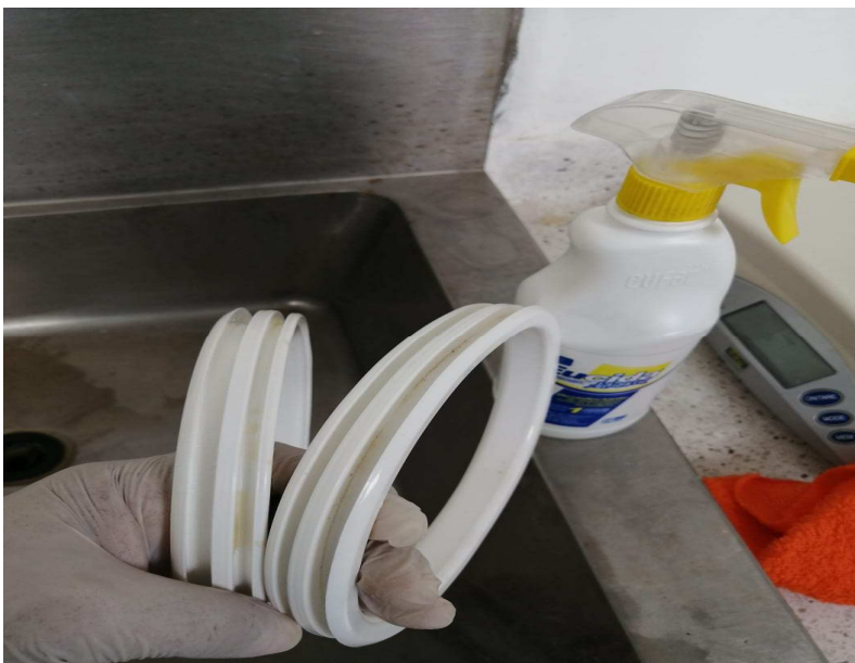
Fig. 96. Preparación de la limpieza y desinfección de los empaques de los tapones.
