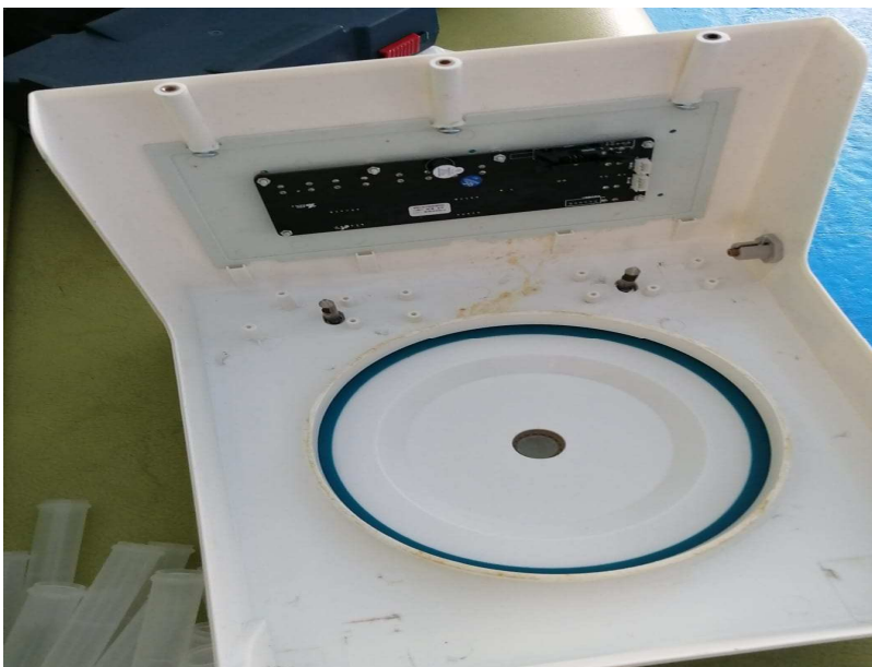
Fig. 41. Tapa externa del equipo en su parte interna presentando un gran estado de sustancias de las muestras de laboratorio.
