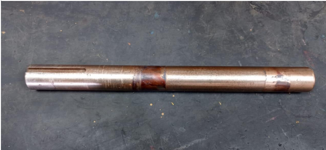
Ilustración 3. Eje del sistema de transmisión de potencia en el radiador del motor Caterpillar 3412y 3408.
