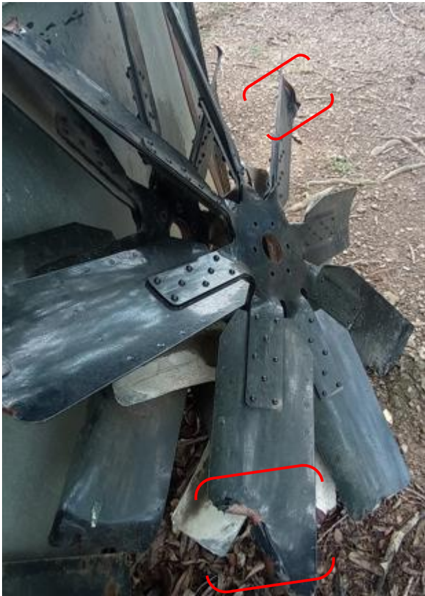
Ilustración 27. Daño de las aspas del radiador por fractura del eje.
