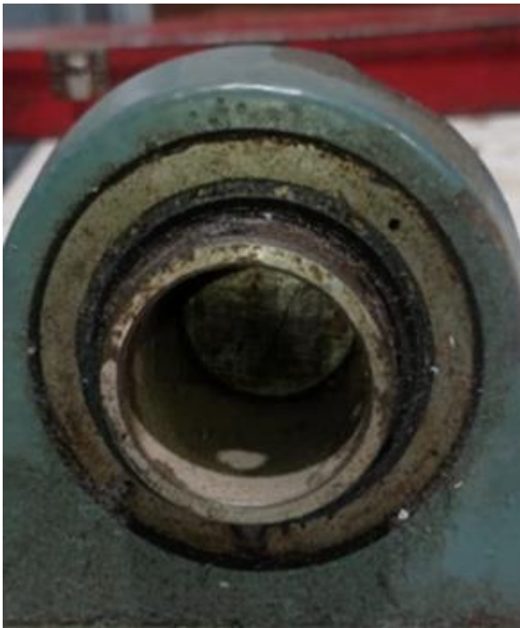
Ilustración 38. Fractura del eje en el asiento de la chumacera
