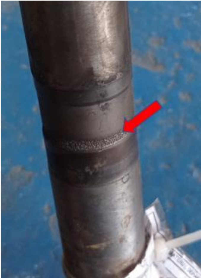
Ilustración 26. Evidencia de corrosión por frotamiento en el eje.
