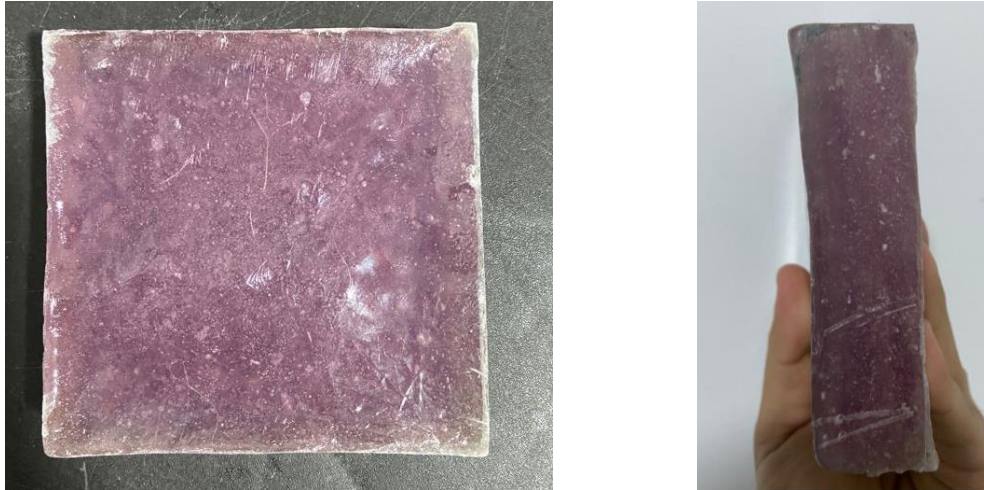
Figura 18. Muestra de compuesto de fibra de vidrio
