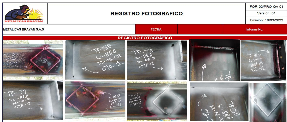
Figura 34: Registro fotográfico de tintas penetrantes
