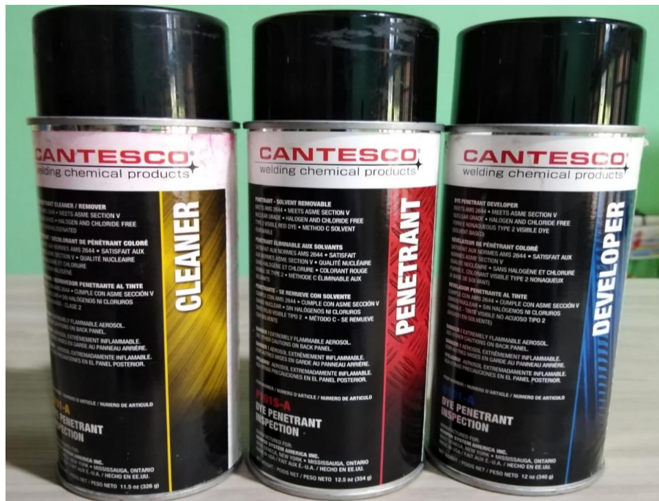
Figura 30: Registro fotográfico de tintas penetrantes
