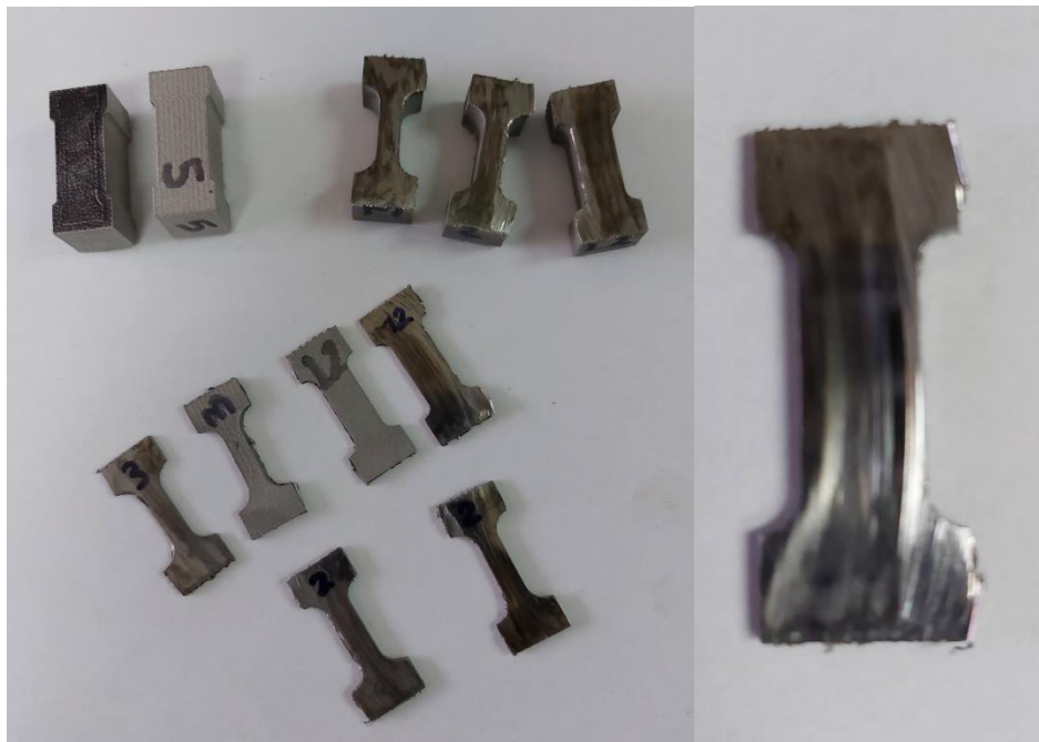
Figura 16. Diferentes probetas a) los cortes que se realizaron b) probeta de 1 mm de espesor.
