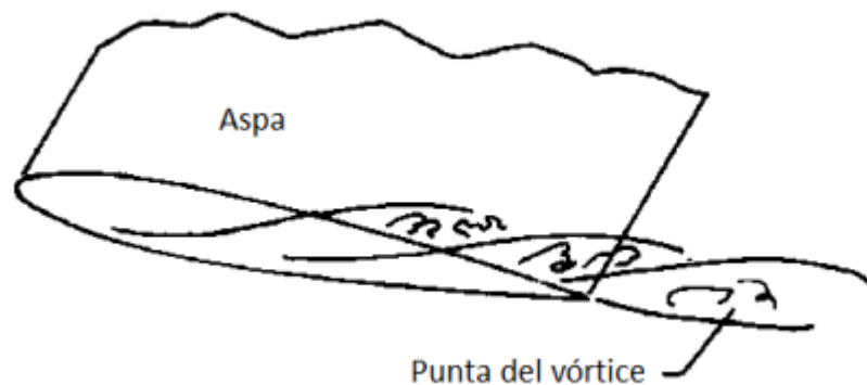
Figura 12: Formación del vórtice en la punta del aspa Fuente: (Presidente et al., n.d.-a)
