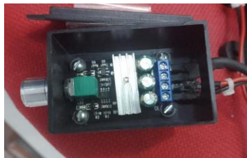
Figura 76. Detalle interno de regulador PWM.
