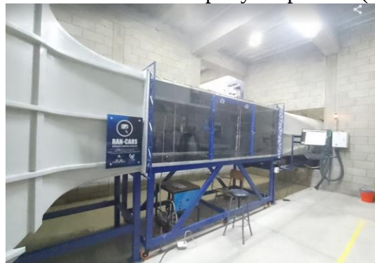
Figura 82. Túnel de viento cubierto con plástico negro para mejor la observación de las líneas de flujo
