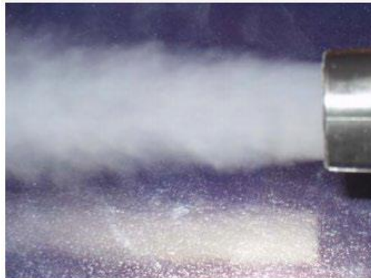
Figura 3. Hielo en humo seco a la salida Fuente: (Barrero, 2003)
