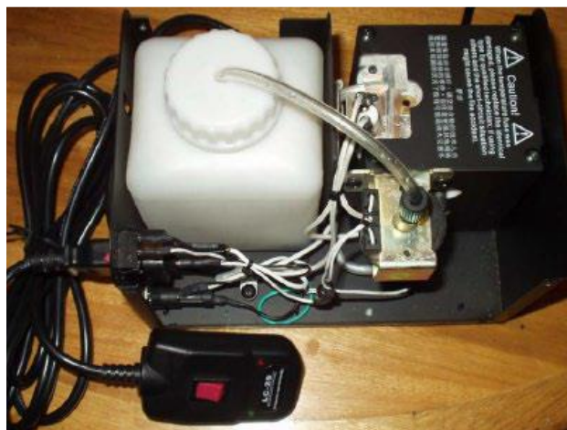
Figura 5. Generador de humo comercial: Humo comercial bajo un sistema de resistencia para calentar el humo Fuente: (Barrero, 2003)
