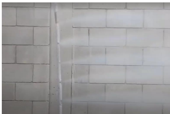
Figura 98. Visualización de las líneas de humo
