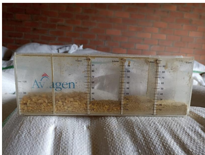
Figura 19. Examen de granulometría en la tamizadora
