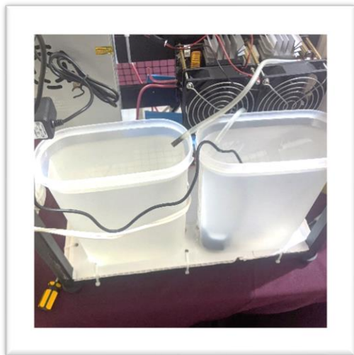
Figura 22. Tanque de almacenamiento de 4 litros.
