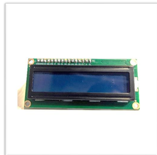
Figura 15. Pantalla LCD 16x2
