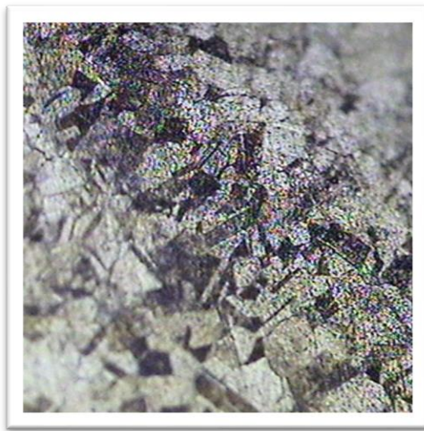
Figura 43. Microestructura de la muestra de acero inoxidable 316L. Aumento de 200X Probeta 1 fatigada térmicamente.
