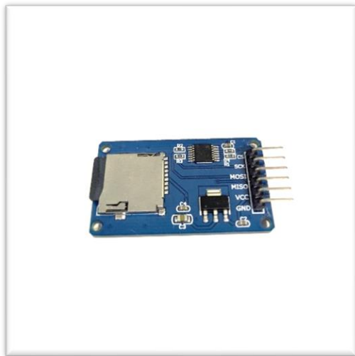
Figura 18. Módulo micro SD.
