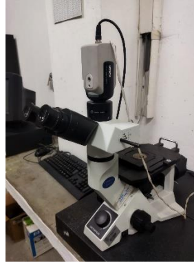
Figura 50. Microscopio metalográfico Olympus GX41.
