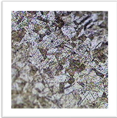
Figura 37. Microestructura sin fatigar del acero inoxidable 316L. Aumento 200X
