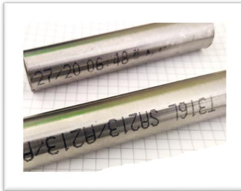
Figura 36. Probetas de 10 cm de acero inoxidable 316L.
