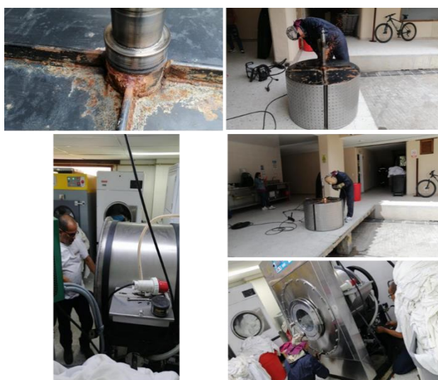
Figura 19: Mantenimiento correctivo a lavadora industrial
