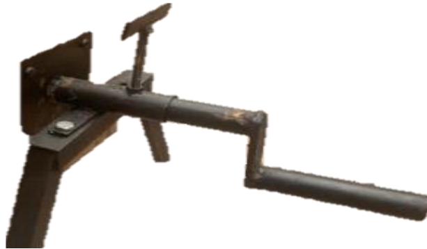
Imagen 17 Sistema biela manivela y Chumacera derecha.
