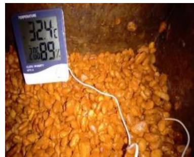
Imagen 38 Ubicación de la sonda cerca de las paredes del recipiente de fermentación.
