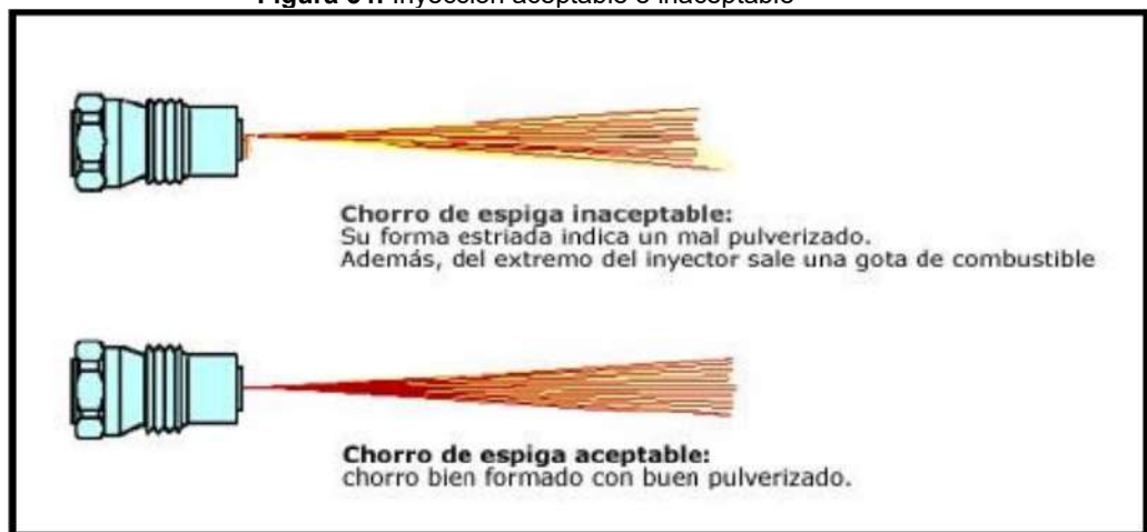
Figura 34: Inyección aceptable e inaceptable
