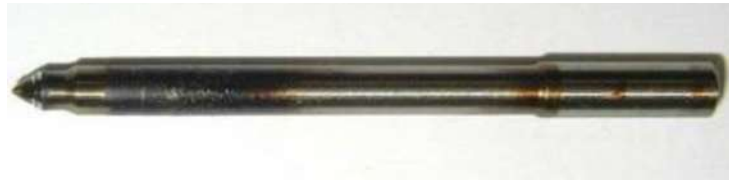
Figura 35: Desgaste en la aguja de la tobera del inyector.
