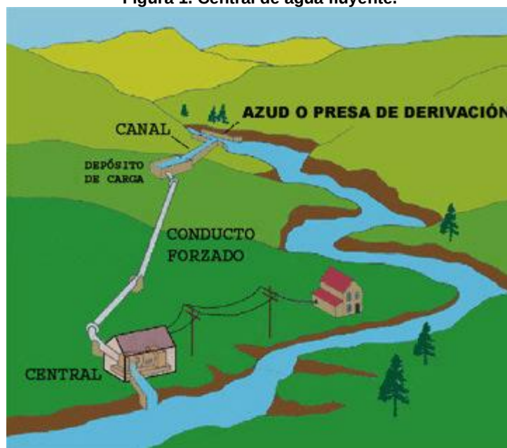
Figura 1. Central de agua fluyente.
