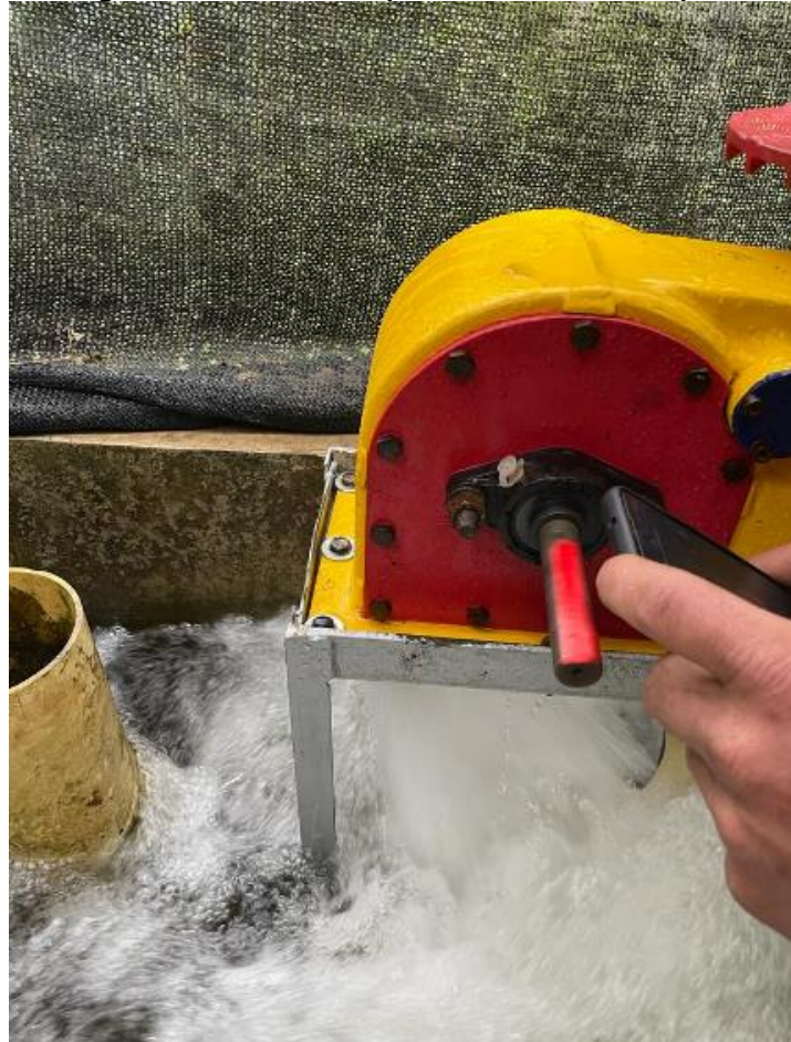
Figura 30. Medición de rpm con luz estrobostrópica
