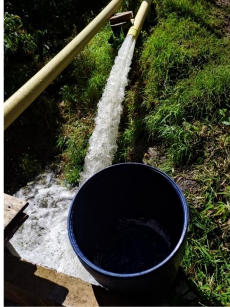
Figura 17. Medición del caudal mediante el llenado de un recipiente.
