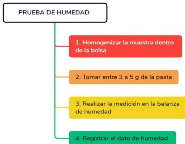
Figura 4. PROCEDIMIENTO TOMA DE HUMEDAD
