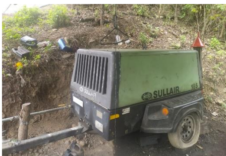
Ilustración 10 Compresor- Fuente: mina Norway
