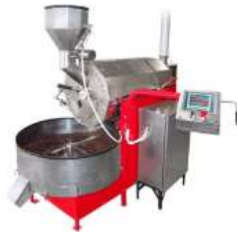
Imagen 15 Nueva máquina tostadora
