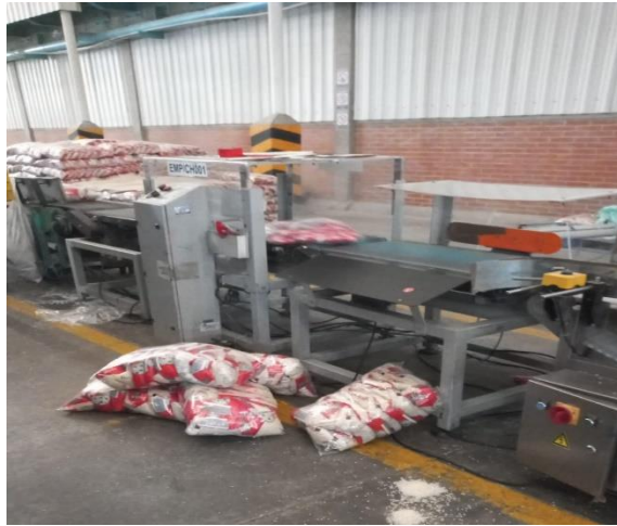
Imagen 2: Maquina detectora de peso y metales.
