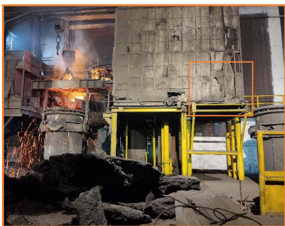
Figura 32. Ubicación Sugerida para Sellado de Tobera
