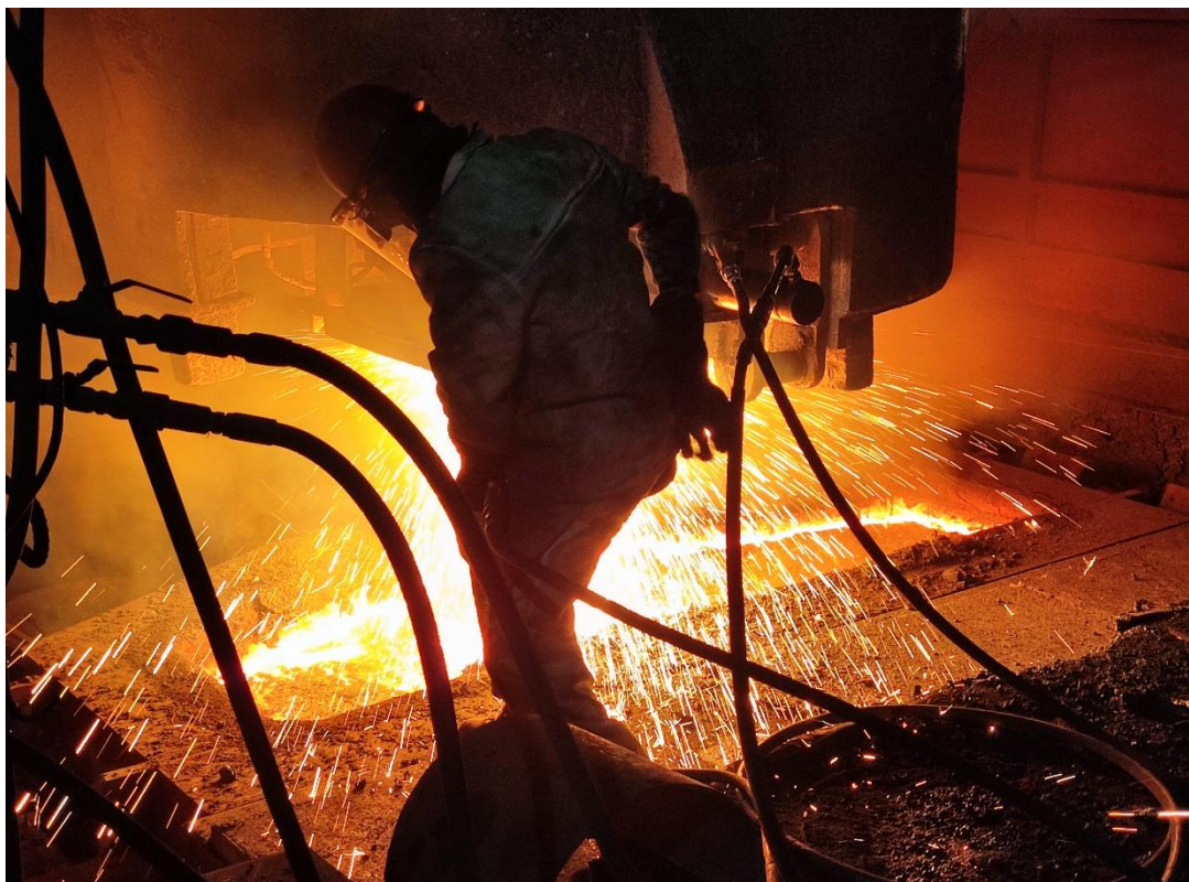
Figura 11. Lanceo para Apertura de Válvula
