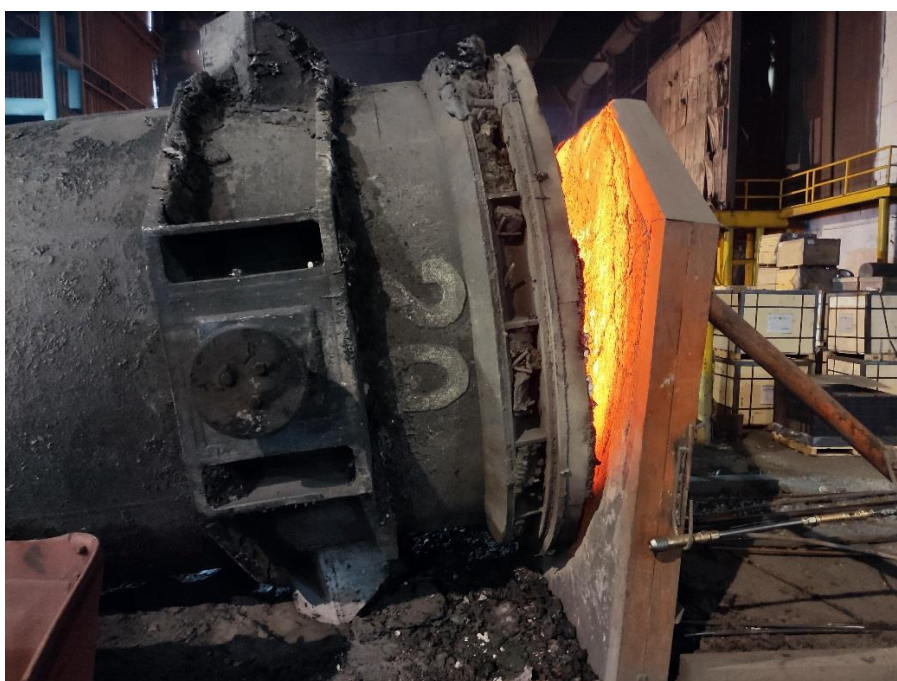
Figura 24. Lugar de Toma de Temperatura de Salida
