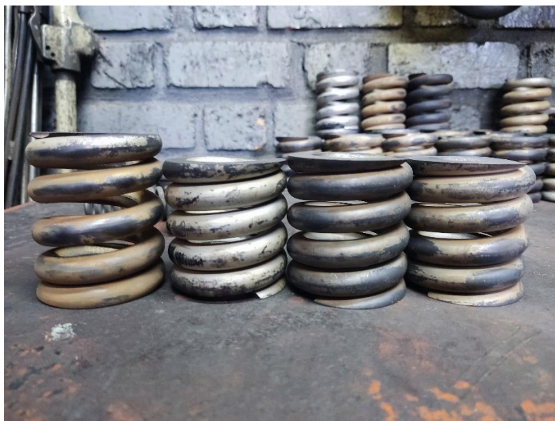
Figura 12. Deformación de resortes a causa de altas temperaturas en la válvula
