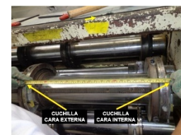
Toma de medida desplazamiento de cabezotes
