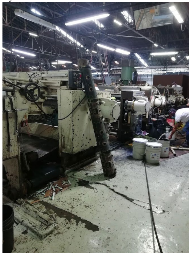
Figura 14. Cuerpos de la máquina flexográfica abiertos para cambio de referencia
