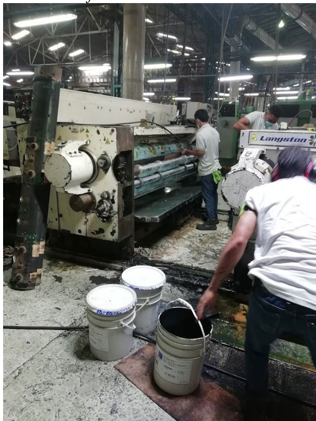
Figura 13. Montaje de troquel durante un cambio de referencia.
