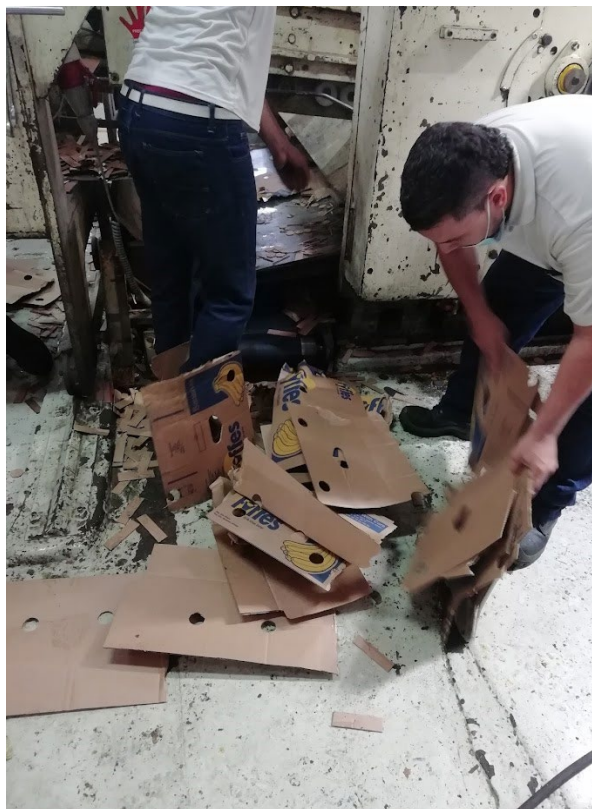
Figura 25. Desperdicio ocasionado por atranque de máquina por material de producción
