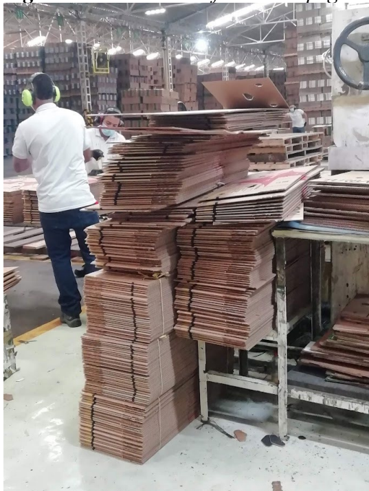
Figura 8. Material con fallo en el pegue de aleta
