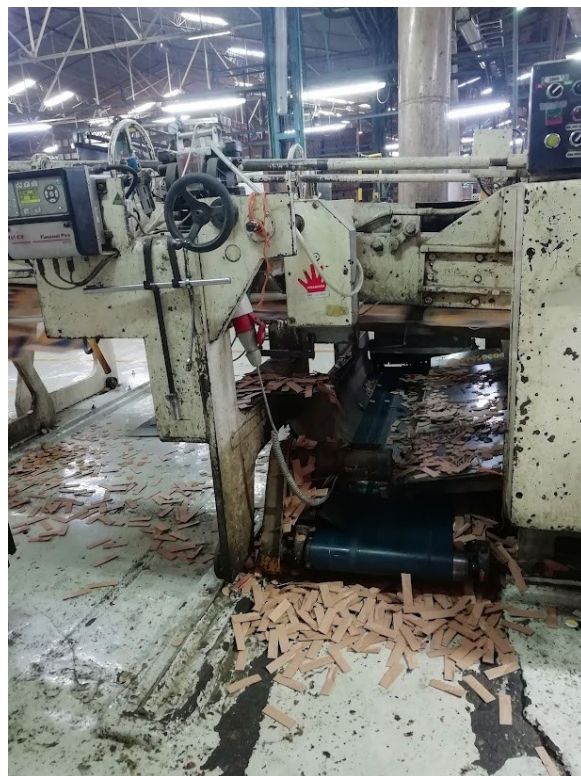
Figura 18. Banda transportadora de desperdicio.
