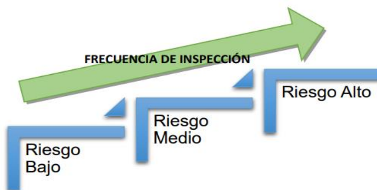
Ilustración 5. Frecuencia de inspección basada en riesgo.
