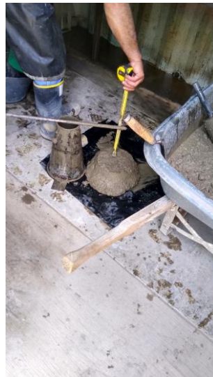
Ilustración Toma de asentamiento de concreto premezclado.
