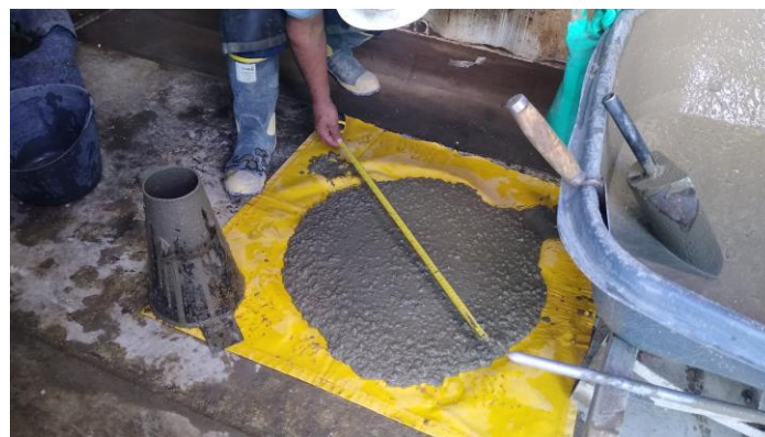
Ilustración Toma de expansión de concreto premezclado
