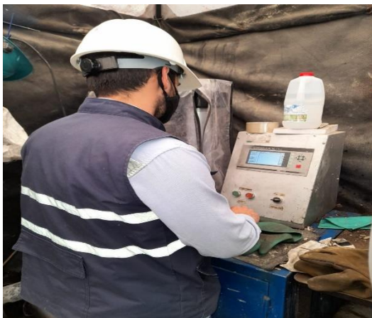
Ilustración 27 Fallo a edades tempranas de concretos
